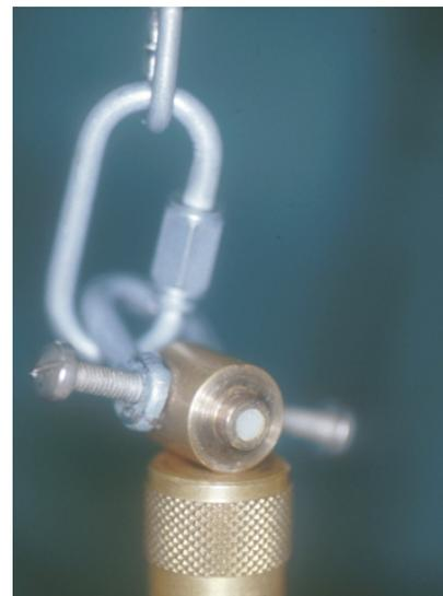
**Abbildung 4:** Stahlhülse mit Komposit
