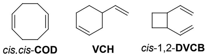
Für den Fall schwach koordinierender Liganden L, die durch Butadien leicht unter Bildung sogenannter 'nackter' Nickelkomplexe verdrängt werden können, kann noch ein drittes Butadien aktiv in den Prozeß der Cyclooligomerisierung einbezogen werden. Für diesen Katalysatortyp ist der [Ni<sup>0</sup>(Butadien)<sub>x</sub>]-Komplex die katalytisch aktive Spezies und es erfolgt bevorzugt die Bildung von C<sub>12</sub>-Cyclotriolefinen. Vom Hauptprodukt der Cyclotrimerisierung
