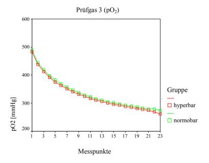
Abb. 12: Messverlauf für das Prüfgasgemisch 3 unter hyperbaren (rote Kurve) und normobaren (grüne Kurve) Bedingungen für O<sub>2</sub>
