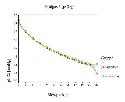
Abb. 15: Messverlauf für das Prüfgasgemisch 3 unter hyperbaren (rote Kurve) und normobaren (grüne Kurve) Bedingungen für CO<sub>2</sub>
