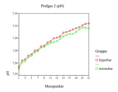
Abb. 17: Messverlauf für das Prüfgasgemisch 2 unter hyperbaren (rote Kurve) und normobaren (grüne Kurve) Bedingungen für pH
