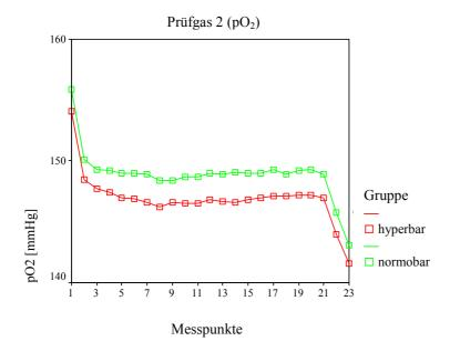
Abb. 11: Messverlauf für das Prüfgasgemisch 2 unter hyperbaren (rote Kurve) und normobaren (grüne Kurve) Bedingungen für O<sub>2</sub>
