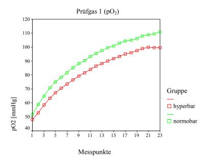
Abb. 10: Messverlauf für das Prüfgasgemisch 1 unter hyperbaren (rote Kurve) und normobaren (grüne Kurve) Bedingungen für O<sub>2</sub>
