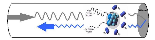
Abb. 02: Messprinzip des Sauerstoffpartialdruckes in der optischen Faser: Die O<sub>2</sub>-Moleküle diffundieren in die Silikonmatrix und verändern die Fluoreszenzeigenschaften des blauen Farbstoffes. Die Menge des reflektierten Fluoreszenzlichtes einer bestimmten Wellenlänge ist proportional dem pO<sub>2</sub>.
