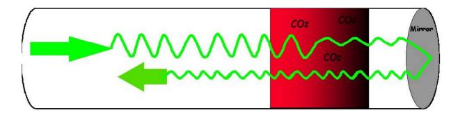
Abb. 03: Messprinzip des Kohlendioxidpartialdruckes in der optischen Faser: CO<sub>2</sub>-Moleküle diffundieren durch eine nur für CO<sub>2</sub> permeable Membran in die Sensormatrix und verändern die Lichtabsorptionseigenschaften eines Farbstoffes. Dieser Farbstoff wird von Licht einer bestimmten Wellenlänge durchstrahlt. Die Energie des rückkehrenden Lichtes ist proportional dem pCO<sub>2</sub>.
