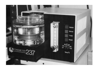
Abb. 06: Tonometer IL 237
