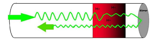
Abb. 04: Messprinzip der Wasserstoffionenkonzentration in der optischen Faser: Protonen (H<sup>+</sup>) diffundieren in den Farbstoff und verändern den pH. Der Farbstoff wird von Licht einer bestimmten Wellenlänge durchstrahlt. Die rückkehrende Lichtenergie ist proportional dem pH.
