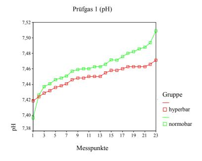
Abb. 16: Messverlauf für das Prüfgasgemisch 1 unter hyperbaren (rote Kurve) und normobaren (grüne Kurve) Bedingungen für pH
