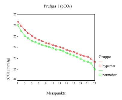
Abb. 13: Messverlauf für das Prüfgasgemisch 1 unter hyperbaren (rote Kurve) und normobaren (grüne Kurve) Bedingungen für CO<sub>2</sub>
