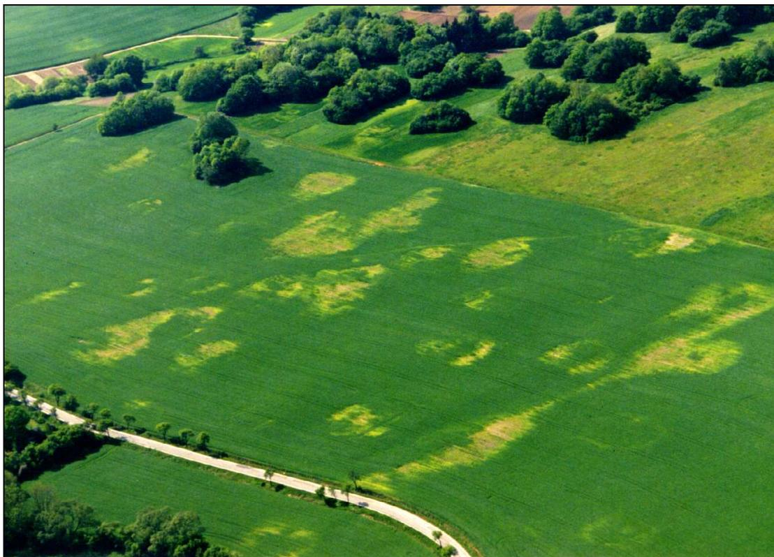
**Abb. A 5: Vegetationsschäden (Chlorosen) über Bodenbereichen mit vergrabendem Schiefermaterial bei Pölsfeld (Foto: Oertel 1998)**
