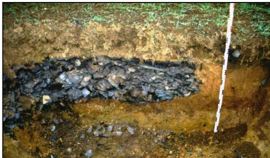
c) Aufschichtung im Bereich der vergrabenen Halde, die den anthropogen eingebrachten sog. "technogenen Haldenhorizont" im Boden verdeutlicht.
