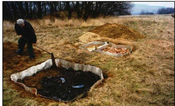
f) Auf beide Gruben, deren Materialfüllungen vergleichbare Wasserleitfähigkeiten aber unterschiedliche Schwermetallgehalte besitzen, wurde Oberboden aus der Umgebung aufgebracht.
