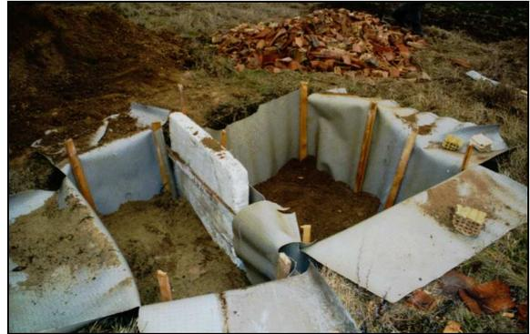
e) Seitenabdichtung der Grube 1, (Sand/ Ziegelschutt), um eine Durchwurzelung der später angebauten Nutzpflanzen zum benachbarten Boden zu verhindern.
