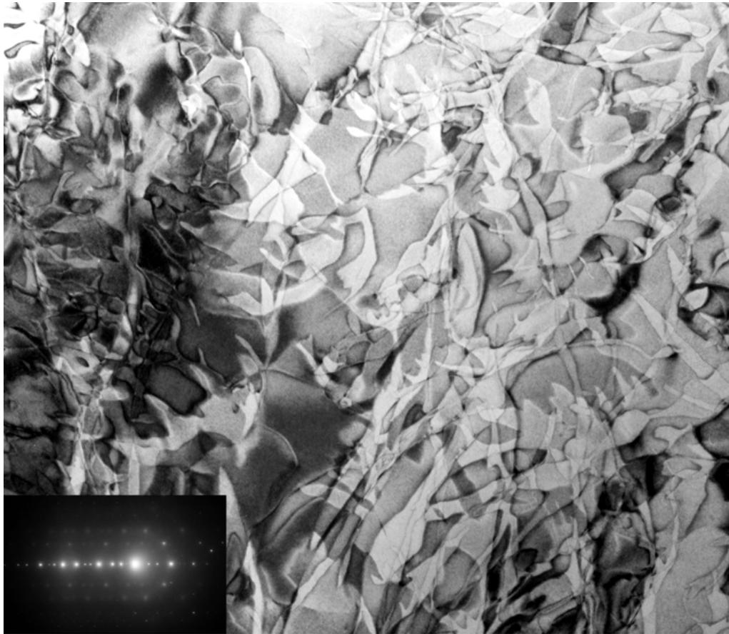
Abb. 3.5: Stereobildpaar einer in 2-zähliger Richtung bei 482^{\circ}\text{C} bis 0,35% plastischer Dehnung verformten Probe. Zur Betrachtung die beiden Bilder einzeln aus einer hochwertigen Kopie (Laserkopierer) ausschneiden und unter einem Stereobetrachter anschauen.
