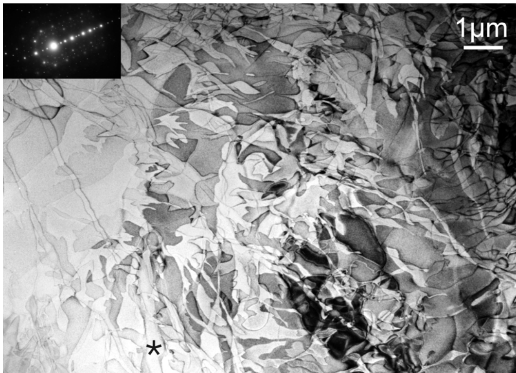
Abb. 6.18: Benachbarte Probenstelle von Abb. 6.16 mit flächenhaften Kontrasten unter \vec{g} = (1/1 \ 0/\bar{1} \ \bar{1}/0) .
