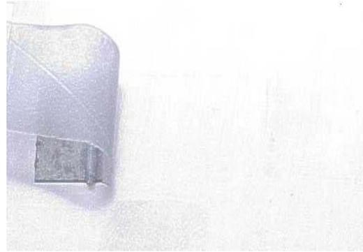
Abb. 15.b) Adhäsives Versagen (Menorest® auf Stahl,  $v = 500$  mm/min)
