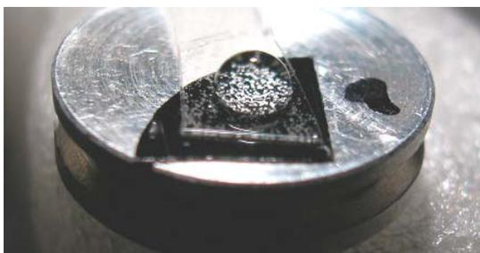
Abb. 70 Versuchsanordnung des statischen Versuches mit aufgesetztem Tropfen
