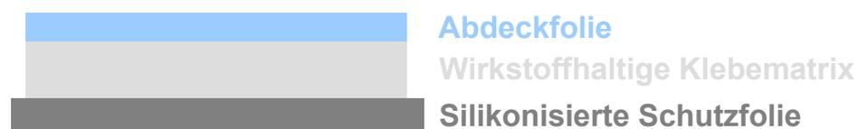
Abb. 2 Schematische Darstellung eines Matrix-TTS
