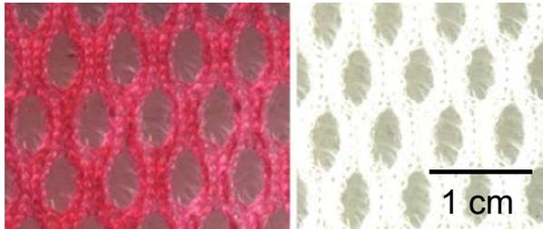
Abb. 37 Abstandsgewirke mit Filetstruktur vor (rechts) und nach (links) der partiellen Beschichtung mit einer farbstoffhaltigen Kleberlösung
