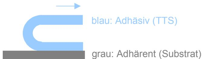
Abb. 8 Schema für 180° Schältest
