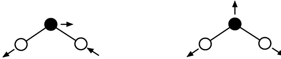
**Abb. 1.3:** Antisymmetrische (links) und symmetrische (rechts) CH<sub>2</sub>-Streckschwingungen.
