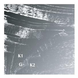
Abb. 4.26: Korngrenze, unpolierte, normaldotierte, gewachsene Ba $_{0,998}$ La $_{0,002}$ TiO $_3$ -Keramik, AFM-Kontaktmodus, leitende Spitze,  $1.5\,\mu\mathrm{m}\cdot 1.5\,\mu\mathrm{m}$ ,  $F_n=2\,\mathrm{nN},\,\Delta\mathrm{z}=60\,\mathrm{nm}$
