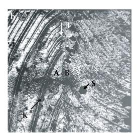
Abb. 4.21: Stufenbündel auf einem Korn, unpolierte, normaldotierte, gewachsene Ba $_{0,998}$ La $_{0,002}$ TiO $_3$ -Keramik, AFM-Kontaktmodus, leitende Spitze,  $4\,\mu\mathrm{m}\cdot4\,\mu\mathrm{m}$ ,  $\mathrm{F}_n=2\,\mathrm{nN}$
