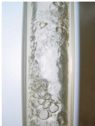
**Bild 8.7: Kolbenblasenströmung**
