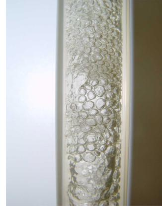
**Bild 8.6: aufgewühlte Strömung**
