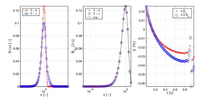
Abbildung 2.35: Simulation A5 - Linkes Diagramm: Partikelverteilung zum Zeitpunkt T=0 und T=1; Mittleres Diagramm: Vergleich der erwarteten (exp) und der berechneten Keimverteilung zum Zeitpunkt T=0 und T=1; Rechtes Diagramm: Vergleich der Fehler für Agglomerationsrate  $\beta_0$  und kummulative Keimbildungsrate  $\sum_i B_{0,i}$
