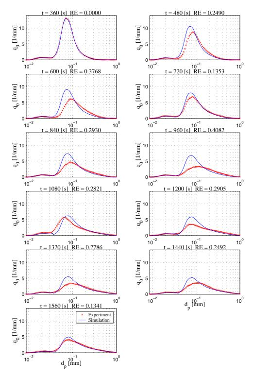
Abbildung G.9: Vergleich Messung und Simulation der Anzahldichteverteilung  $q_0$  - Versuch  $300404\mathrm{A}$
