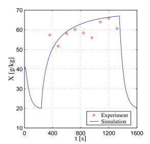
Abbildung 4.48: Vergleich zwischen dem simulierten und gemessenen Gasmassendurchsatz Versuch: 180504B
