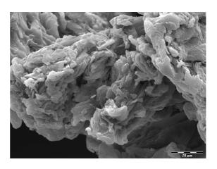
Abbildung 4.21: Probe 1 des Versuchs 220404A nach t = 360s (1000-fache Vergrößerung, Messbalken entspricht  $20\mu m$ )
