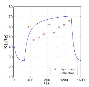
Abbildung G.31: Vergleich zwischen dem simulierten und gemessenen Gasmassendurchsatz Versuch: 220404D
