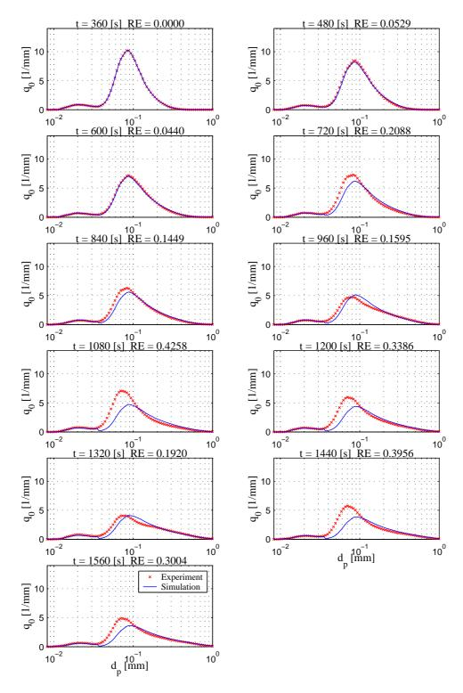
Abbildung G.14: Vergleich Messung und Simulation der Anzahldichteverteilung  $q_0$  - Versuch  $260504\mathrm{B}$
