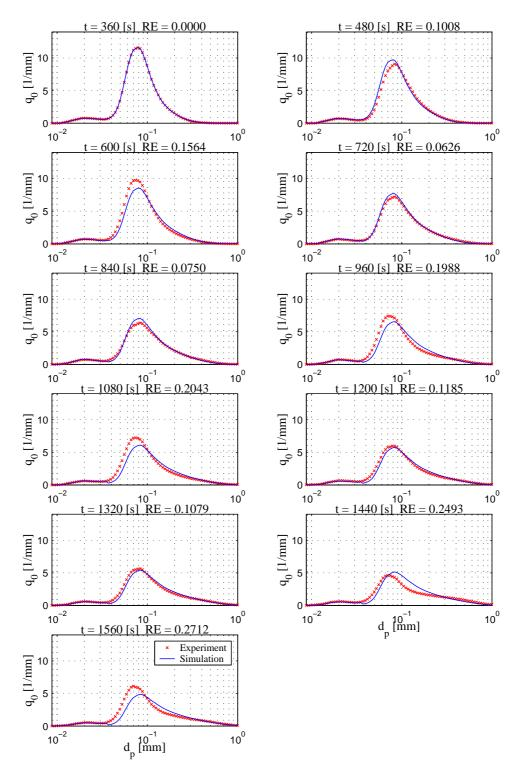
Abbildung G.13: Vergleich Messung und Simulation der Anzahldichteverteilung  $q_0$  - Versuch  $260504\mathrm{A}$
