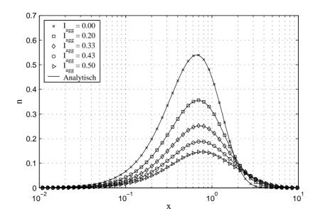
Abbildung 2.13: Vergleich zwischen numerischer und analytischer Lösung für konstanten Kern entsprechend der Gleichung (2.17) mit  $v_2=N_0=1$  und  $\nu=a=2$
