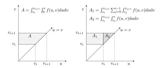
Abbildung 2.9: Fehlender Integrationsbereich bei der Bestimmung der Entstehungsrate
