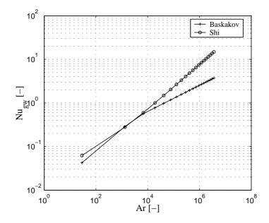
Abbildung C.1: Vergleich der Modelle von Baskakov u. a. (1973) und Shi für  $T_g=50^\circ C,\,Re_0=10,\,\varrho_p=1000kg/m^3$  und  $d_p=0.1-5mm$
