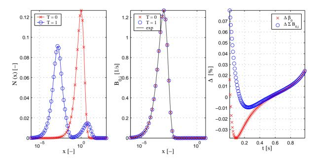
Abbildung 2.34: Simulation A4 - Linkes Diagramm: Partikelverteilung zum Zeitpunkt T=0 und T=1; Mittleres Diagramm: Vergleich der erwarteten (exp) und der berechneten Keimverteilung zum Zeitpunkt T=0 und T=1; Rechtes Diagramm: Vergleich der Fehler für Agglomerationsrate  $\beta_0$  und kummulative Keimbildungsrate  $\sum_i B_{0,i}$
