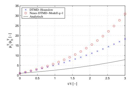
Abbildung 2.26: Vergleich des zeitlichen Verlaufs des normierten  $\mu_1^T/\mu_0^T$ -Momentes bei Summenkern für das Gitter  $v_{i+1}/v_i=2^q$  mit q=1 und  $I_{agg}=1/4$  für DTMD-Hounslow nach Gleichung (2.66) und neues DTMD-Modell nach Gleichung (2.79)
