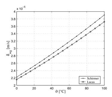
Abbildung B.1: Vergleich der Modelle von Schirmer (1938) und Lucas u. Luckas (1994) für P=100000 Pa
