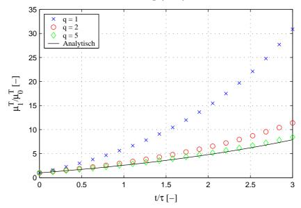
Abbildung 2.27: Einfluss der Diskretisierung auf den zeitlichen Verlauf des normierten  $\mu_1^T/\mu_0^T$ -Momentes des Tracers bei Summenkern unter Verwendung des neuen DTMD-Modells nach Gleichung (2.79) für ein anpassbares Gitter  $v_{i+1}/v_i=2^q$  mit q=1,2,5 und  $I_{agg}=1/4$
