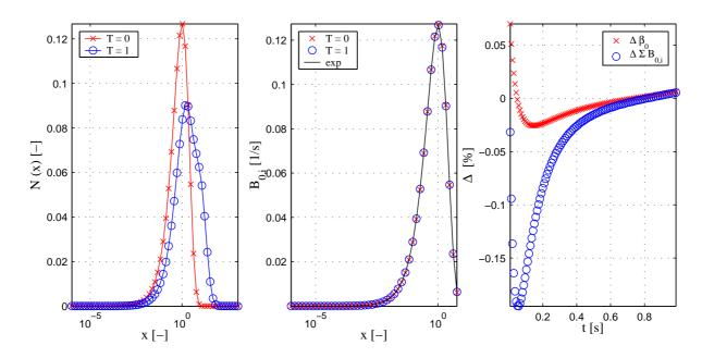
Abbildung 2.31: Simulation A1 - Linkes Diagramm: Partikelverteilung zum Zeitpunkt T=0 und T=1s; Mittleres Diagramm: Vergleich der erwarteten (exp) und der berechneten Keimverteilung zum Zeitpunkt T=0 und T=1; Rechtes Diagramm: Vergleich der Fehler für Agglomerationsrate  $\beta_0$  und kummulative Keimbildungsrate  $\sum_i B_{0,i}$
