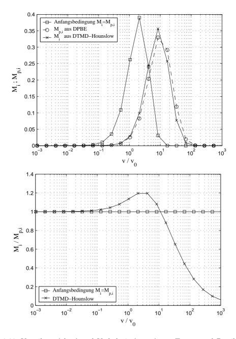
Abbildung 2.20: Verteilung (oben) und Verhältnis (unten) von Tracer- und Partikelmasse für DTMD-Modell nach Hounslow u. a. (2001) entsprechend Gleichung (2.66) für Exponentialverteilung als Anfangsbedingung nach Gleichung (2.25) mit  $N_0=v_0=1$ , konstanten Kern  $\beta_0=1$  und  $I_{agg}=0.8$
