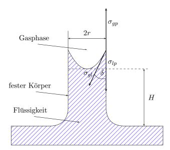
Abbildung 4.6: Mechanismus der Kapillarkondensation nach Bathen u. Breitbach (2001)
