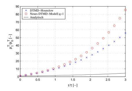
Abbildung 2.28: Vergleich des zeitlichen Verlaufs des normierten  $\mu_1^T/\mu_0^T$ -Momentes bei Produktkern für das Gitter  $v_{i+1}/v_i=2^q$  mit q=1 und  $I_{agg}=1/4$  für DTMD-Hounslow nach Gleichung (2.66) und neues DTMD-Modell nach Gleichung (2.79)
