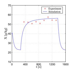
Abbildung G.35: Vergleich zwischen dem simulierten und gemessenen Gasmassendurchsatz Versuch: 260404A
