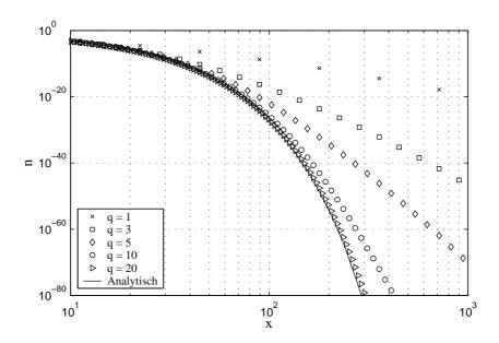
Abbildung 2.19: Einfluss des Diskretisierungsfaktors q auf die numerische Lösung für konstanten Kern entsprechend der Gleichung (2.17) mit  $v_2=N_0=1,~\nu=a=2$  und  $I_{agg}=0.5$
