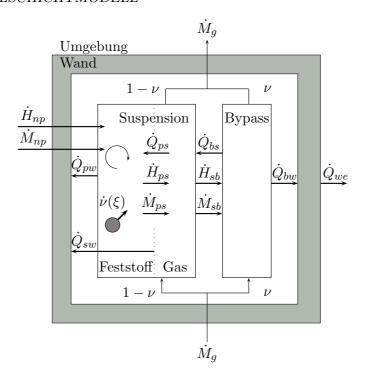
Abbildung 3.1: Modifiziertes zweiphasiges Wirbelschichtmodell nach Burgschweiger (2000)
