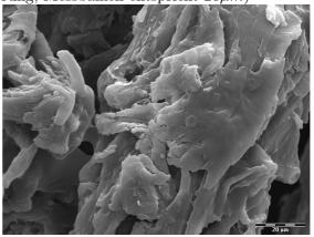
Abbildung 4.23: Probe 6 des Versuchs 220404A nach t = 960s (1000-fache Vergrößerung, Messbalken entspricht  $20\mu m$ )
