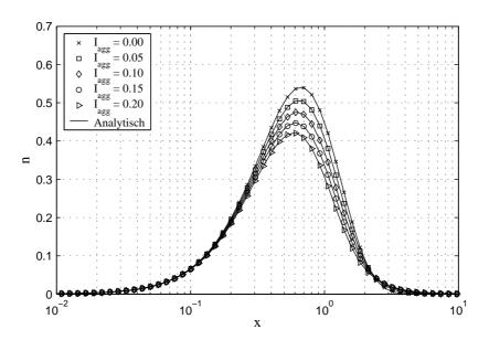
Abbildung 2.17: Vergleich zwischen numerischer und analytischer Lösung für Produktkern entsprechend der Gleichung (2.21) mit  $v_2=N_0=1$  und  $\nu=a=2$
