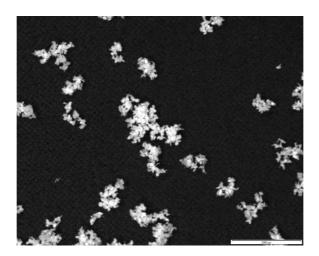
Abbildung 4.18: Probe 6 des Versuchs 220404A nach t=960s (10-fache Vergrößerung, Messbalken entspricht  $2000\mu m)$
