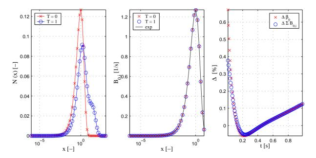
Abbildung 2.32: Simulation A2 - Linkes Diagramm: Partikelverteilung zum Zeitpunkt T=0 und T=1; Mittleres Diagramm: Vergleich der erwarteten (exp) und der berechneten Keimverteilung zum Zeitpunkt T=0 und T=1; Rechtes Diagramm: Vergleich der Fehler für Agglomerationsrate  $\beta_0$  und kummulative Keimbildungsrate  $\sum_i B_{0,i}$
