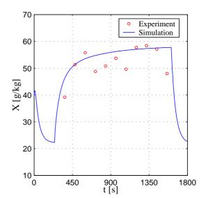
Abbildung 4.40: Vergleich zwischen dem simulierten und gemessenen Gasmassendurchsatz Versuch: 060504B
