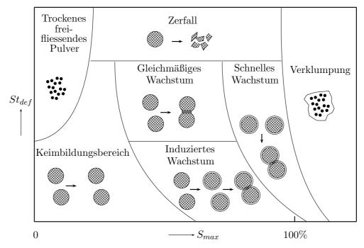
Abbildung 1.2: Bereich des Partikelwachstums nach Iveson u. Litster (1998)
