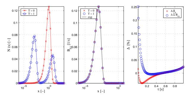
Abbildung 2.33: Simulation A3 - Linkes Diagramm: Partikelverteilung zum Zeitpunkt T=0 und T=1; Mittleres Diagramm: Vergleich der erwarteten (exp) und der berechneten Keimverteilung zum Zeitpunkt T=0 und T=1; Rechtes Diagramm: Vergleich der Fehler für Agglomerationsrate  $\beta_0$  und kummulative Keimbildungsrate  $\sum_i B_{0,i}$
