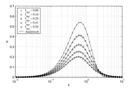
Abbildung 2.15: Vergleich zwischen numerischer und analytischer Lösung für Summenkern entsprechend der Gleichung (2.19) mit  $v_2=N_0=1$  und  $\nu=a=2$
