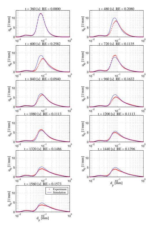
Abbildung 4.29: Vergleich Messung und Simulation der Anzahldichteverteilung  $q_0$  - Versuch  $060504\mathrm{B}$
