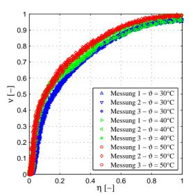
Abbildung 4.12: Normierte Trocknungskurven mit kritischer Partikelfeuchte  $X_c = 600g/kg$  für alle Messungen
