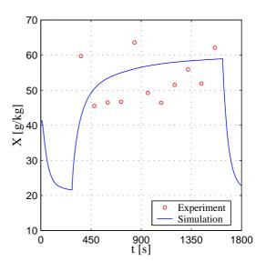
Abbildung 4.36: Vergleich zwischen dem simulierten und gemessenen Gasmassendurchsatz Versuch: 060504A
