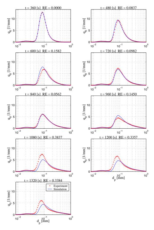
Abbildung G.2: Vergleich Messung und Simulation der Anzahldichteverteilung  $q_0$  - Versuch  $220404\mathrm{B}$
