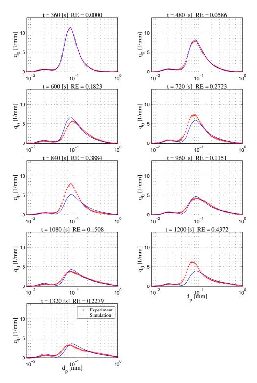
Abbildung G.6: Vergleich Messung und Simulation der Anzahldichteverteilung  $q_0$  - Versuch  $280404\mathrm{A}$
