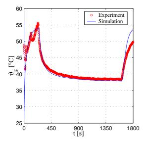
Abbildung 4.38: Vergleich zwischen der berechneten und gemessenen Gastemperatur Versuch: 060504B
