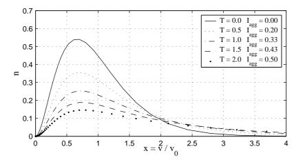
Abbildung 2.6: Analytische Lösung für konstanten Kern nach Gleichung (2.17) mit  $\beta_0=1,$   $v_2=N_0=1$  und  $\nu=a=2$
