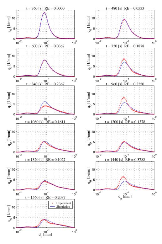
Abbildung G.7: Vergleich Messung und Simulation der Anzahldichteverteilung  $q_0$  - Versuch  $280404\mathrm{B}$
