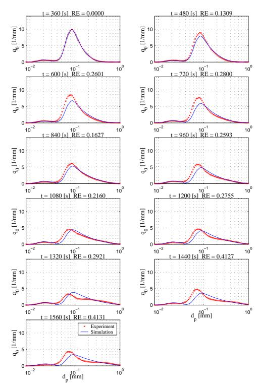
Abbildung G.15: Vergleich Messung und Simulation der Anzahldichteverteilung  $q_0$  - Versuch  $270504\mathrm{A}$
