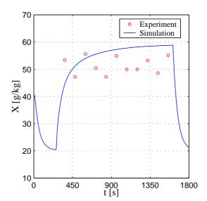
Abbildung G.51: Vergleich zwischen dem simulierten und gemessenen Gasmassendurchsatz Versuch: 300404A
