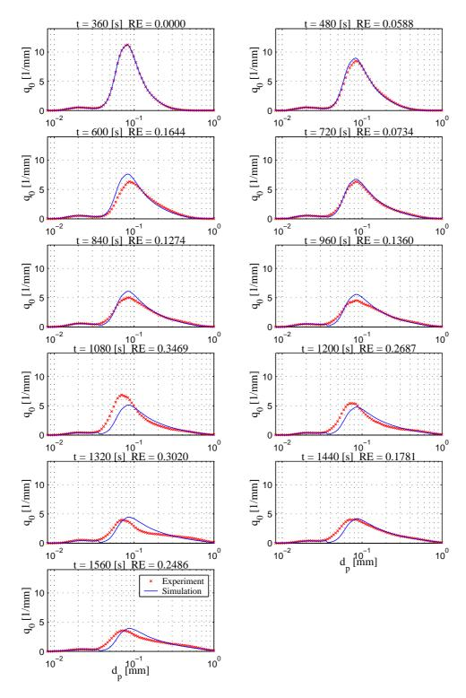
Abbildung G.8: Vergleich Messung und Simulation der Anzahldichteverteilung  $q_0$  - Versuch  $280404\mathrm{C}$
