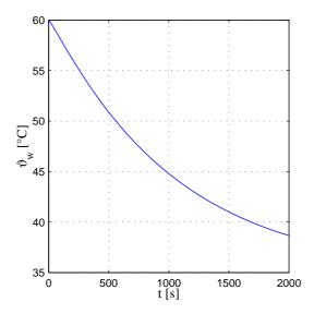
Abbildung 3.15: Wandtemperatur (Simulation Eindüsung 1)
