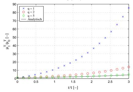
Abbildung 2.29: Einfluss der Diskretisierung auf den zeitlichen Verlauf des normierten  $\mu_1^T/\mu_0^T$ Momentes des Tracers bei Produktkern unter Verwendung des neuen DTMD-Modells nach Gleichung (2.79) für ein anpassbares Gitter  $v_{i+1}/v_i = 2^q$  mit q = 1, 2, 5 und  $I_{agg} = 1/8$
