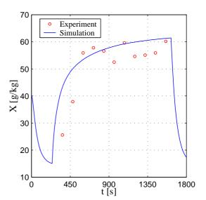
Abbildung G.71: Vergleich zwischen dem simulierten und gemessenen Gasmassendurchsatz Versuch: 260504B
