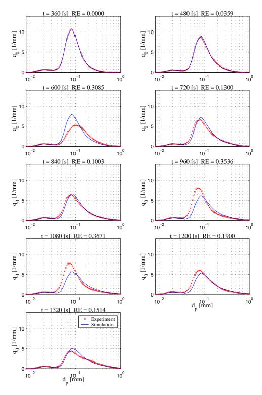
Abbildung 4.30: Vergleich Messung und Simulation der Anzahldichteverteilung  $q_0$  - Versuch  $180504\mathrm{A}$
