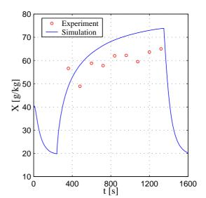
Abbildung G.59: Vergleich zwischen dem simulierten und gemessenen Gasmassendurchsatz Versuch: 190504A
