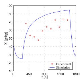
Abbildung G.43: Vergleich zwischen dem simulierten und gemessenen Gasmassendurchsatz Versuch: 280404B
