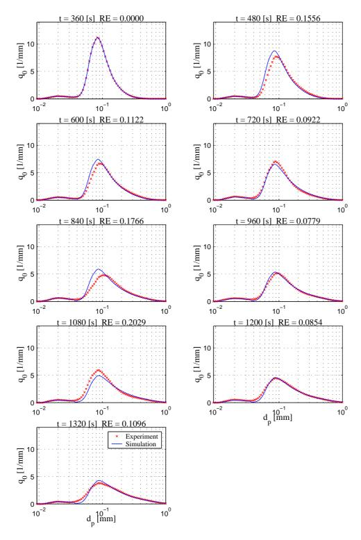
Abbildung G.4: Vergleich Messung und Simulation der Anzahldichteverteilung  $q_0$  - Versuch  $220404\mathrm{D}$
