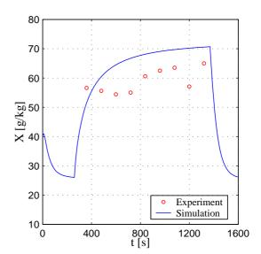
Abbildung G.27: Vergleich zwischen dem simulierten und gemessenen Gasmassendurchsatz Versuch: 220404C
