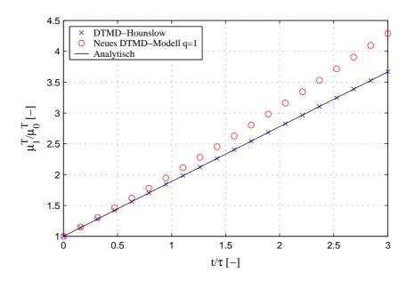
Abbildung 2.24: Vergleich des zeitlichen Verlaufs des normierten  $\mu_1^T/\mu_0^T$ -Momentes bei konstantem Kern für das Gitter  $v_{i+1}/v_i=2^q$  mit q=1 und  $I_{agg}=1/4$  für DTMD-Hounslow nach Gleichung (2.66) und neues DTMD-Modell nach Gleichung (2.79)
