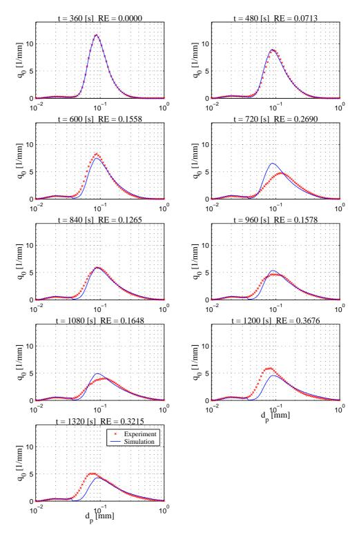
Abbildung G.1: Vergleich Messung und Simulation der Anzahldichteverteilung  $q_0$  - Versuch  $220404\mathrm{A}$
