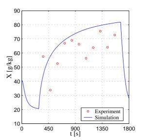
Abbildung G.79: Vergleich zwischen dem simulierten und gemessenen Gasmassendurchsatz Versuch: 270504B
