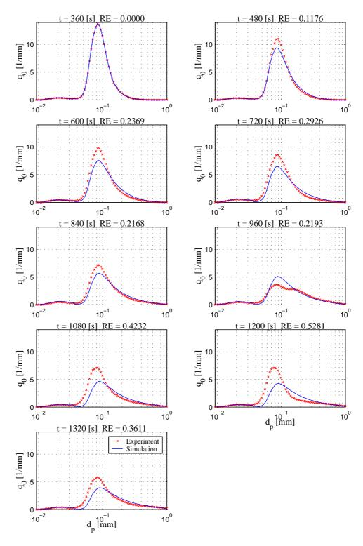
Abbildung G.5: Vergleich Messung und Simulation der Anzahldichteverteilung  $q_0$  - Versuch  $260404\mathrm{A}$
