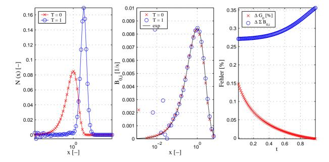
Abbildung 2.37: Simulation B2 - Linkes Diagramm: Partikelverteilung zum Zeitpunkt T=0 und T=1; Mittleres Diagramm: Vergleich der erwarteten (exp) und der berechneten Keimverteilung zum Zeitpunkt T=0 und T=1; Rechtes Diagramm: Vergleich der Fehler für Wachstumsrate  $G_0$  und kummulative Keimbildungsrate  $\sum_i B_{0,i}$
