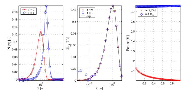
Abbildung 2.36: Simulation B1 - Linkes Diagramm: Partikelverteilung zum Zeitpunkt T=0 und T=1; Mittleres Diagramm: Vergleich der erwarteten (exp) und der berechneten Keimverteilung zum Zeitpunkt T=0 und T=1; Rechtes Diagramm: Vergleich der Fehler für Wachstumsrate  $G_0$  und kummulative Keimbildungsrate  $\sum_i B_{0,i}$
