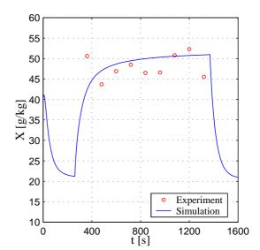
Abbildung G.23: Vergleich zwischen dem simulierten und gemessenen Gasmassendurchsatz Versuch: 220404B
