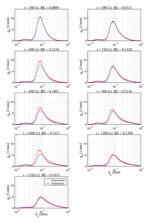
Abbildung G.11: Vergleich Messung und Simulation der Anzahldichteverteilung  $q_0$  - Versuch  $190504\mathrm{A}$
