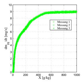
Abbildung 4.9: Messung des Trocknungsverlaufes von MCC bei  $\vartheta_g=30^{\circ}C$
