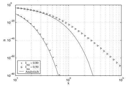
Abbildung 2.14: Vergrößerung des Fehlers aus Abbildung 2.13 für konstanten Kern entsprechend der Gleichung (2.17) mit  $v_2=N_0=1$  und  $\nu=a=2$
