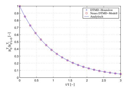
Abbildung 2.22: Zeitlicher Verlauf des  $\mu_0^T$ -Momentes des Tracers bei konstantem Kern ( $I_{agg}=1/4$ )
