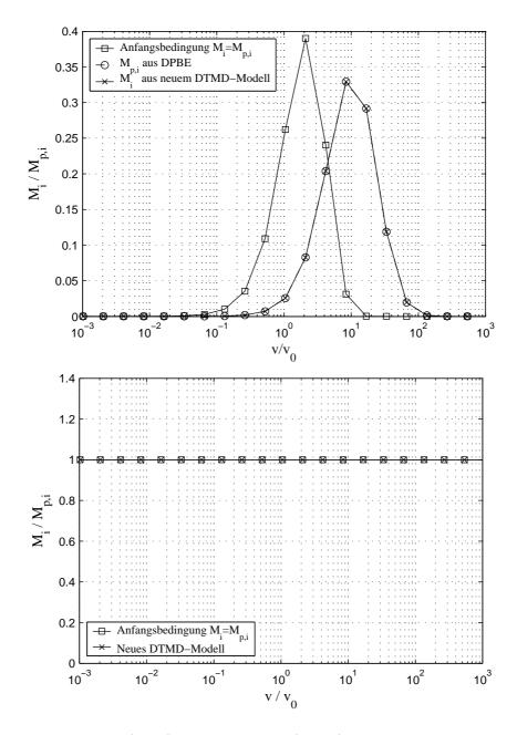
Abbildung 2.21: Verteilung (oben) und Verhältnis (unten) von Tracer- und Partikelmasse für neues DTMD-Modell entsprechend Gleichung (2.71) für Exponentialverteilung als Anfangsbedingung nach Gleichung (2.25) mit  $N_0 = v_0 = 1$ , konstanten Kern  $\beta_0 = 1$  und  $I_{agg} = 0.8$
