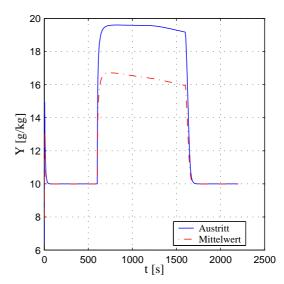
Abbildung 3.26: Zeitlicher Verlauf der Gasbeladung (Simulation des vollständigen Prozesses Beispiel 2)
