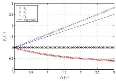
Abbildung 2.23: Zeitlicher Verlauf des normierten  $\mu_0$ - und  $\mu_2$ -Momentes der Partikelanzahl bei konstantem Kern  $(I_{agg}=3/5)$
