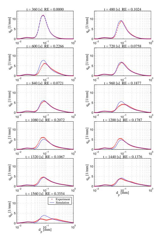
Abbildung G.10: Vergleich Messung und Simulation der Anzahldichteverteilung  $q_0$  - Versuch  $300404\mathrm{B}$
