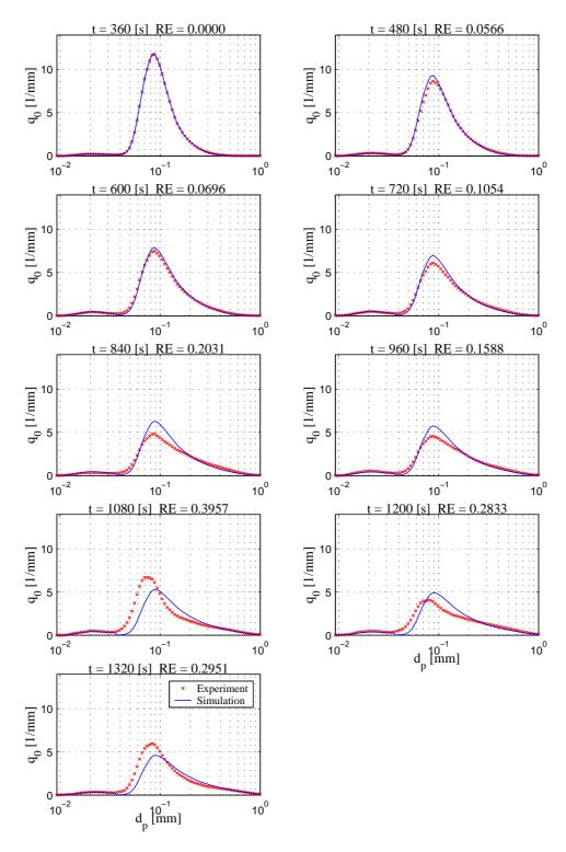
Abbildung G.3: Vergleich Messung und Simulation der Anzahldichteverteilung  $q_0$  - Versuch  $220404\mathrm{C}$
