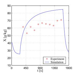
Abbildung G.47: Vergleich zwischen dem simulierten und gemessenen Gasmassendurchsatz Versuch: 280404C
