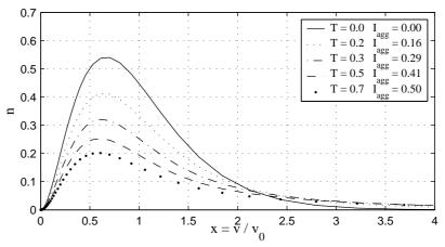
Abbildung 2.7: Analytische Lösung für Summenkern nach Gleichung (2.19) mit  $\beta_0=1,\ v_2=N_0=1$  und  $\nu=a=2$
