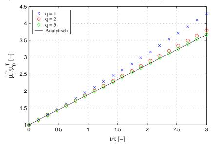
Abbildung 2.25: Einfluss der Diskretisierung auf den zeitlichen Verlauf des normierten  $\mu_1^T/\mu_0^T$ Momentes des Tracers bei konstanten Kern unter Verwendung des neuen DTMD-Modells nach Gleichung (2.79) für ein anpassbares Gitter  $v_{i+1}/v_i=2^q$  mit q=1,2,5 und  $I_{agg}=1/4$
