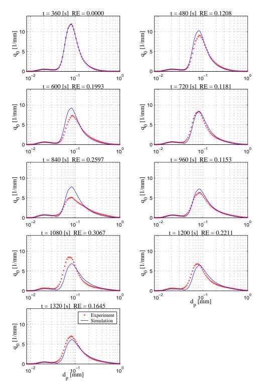
Abbildung 4.31: Vergleich Messung und Simulation der Anzahldichteverteilung  $q_0$  - Versuch  $180504\mathrm{B}$
