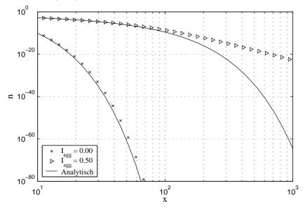
Abbildung 2.16: Vergrößerung des Fehlers aus Abbildung 2.15 für Summenkern entsprechend der Gleichung (2.19) mit  $v_2=N_0=1$  und  $\nu=a=2$
