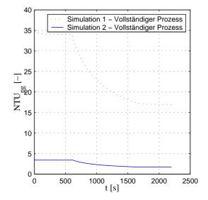
Abbildung 3.29: Verlauf des Trocknungspotentials in Abhängigkeit von  $NTU_{pg}$
