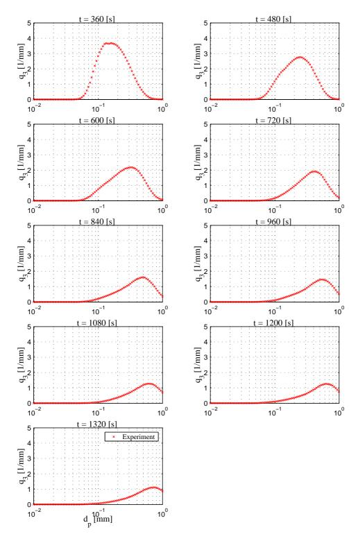
Abbildung 4.27: Berechnete Massendichteverteilung  $q_3$  (berechnet aus gemessener Anzahldichteverteilung  $q_0$ ) - Versuch 220404A
