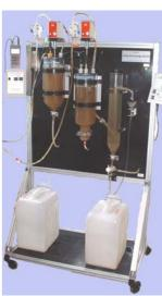
Abbildung 4-3: Schematische Darstellung und Fotografie der Modellkläranlage II mit vorgeschalteter Denitrifikation (B 1 = Abwasservorratsgefäß, gekühlt, B 2 = anoxisches Denitrifikationsbecken, B 3 = Belebungsbecken, NB = Nachklärbecken, P = Schlauchpumpen)
