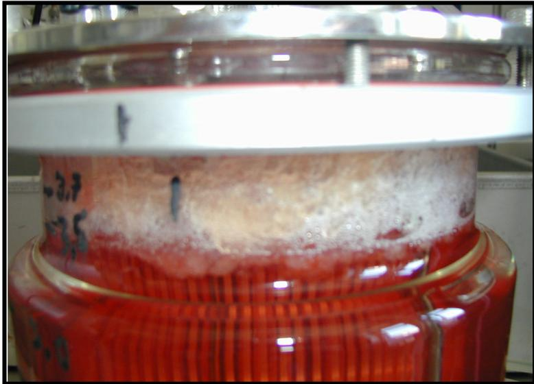
Abbildung 4-44: Fotografische Aufnahme des 3,5 L Bioreaktors im Testlauf mit Sparging unmittelbar nach Inokulation. Dargestellt ist eine Nahaufnahme des oberen Teils des Reaktors.
