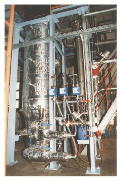
Abb. 4.1: Wirbelschichtvergasungs-Versuchsanlage WSV 400
