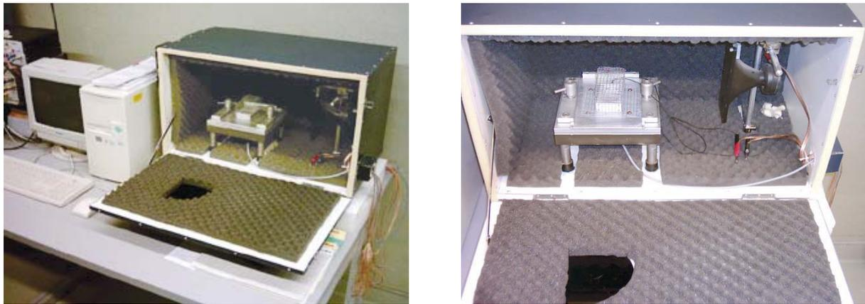
Abb.9. Testapparatur für die akustische Schreckreaktion
