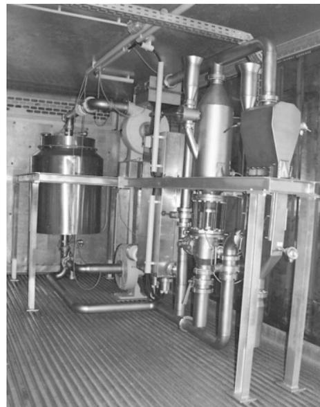
Abbildung 2.1: Wirbelschichtgefriertrocknungsanlage im Tiefkühlcontainer
