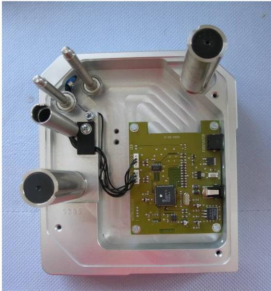
Bild 26 - Gehäuse mit teilweise montierten Bauteilen für ein Laborgerät aus Aluminium
