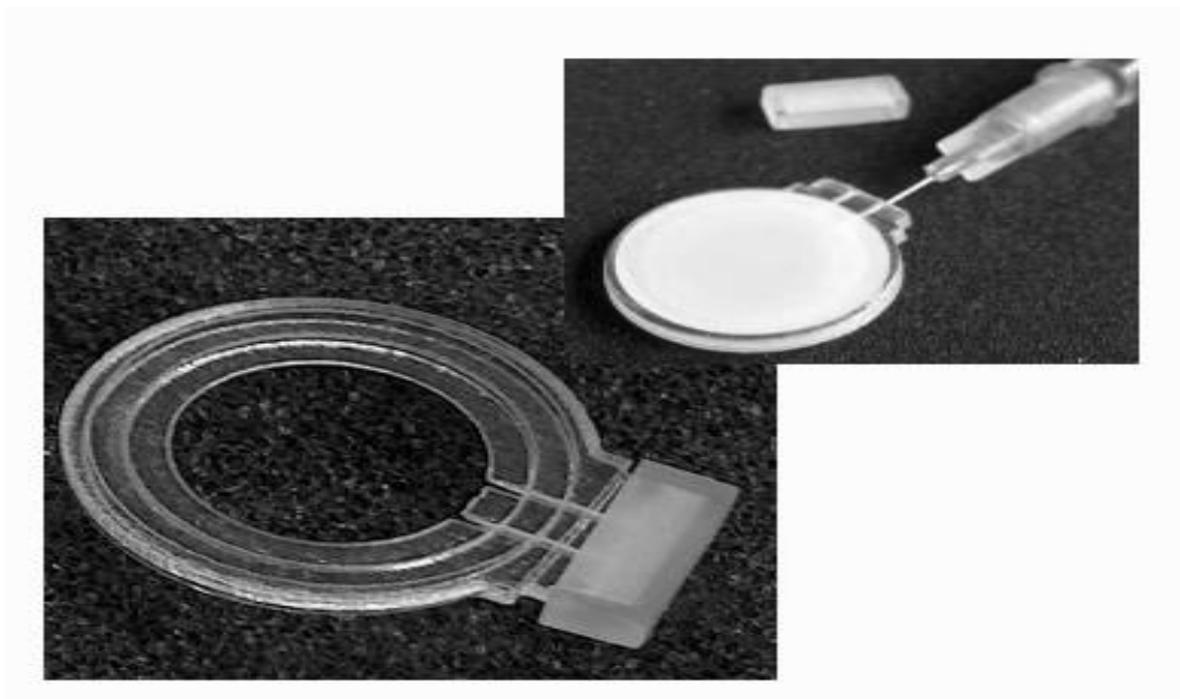
Bild 42 - Beispiel für eine Zellkammer der 1. Generation, Kammerrahmen hergestellt mit der Objet Technologie
