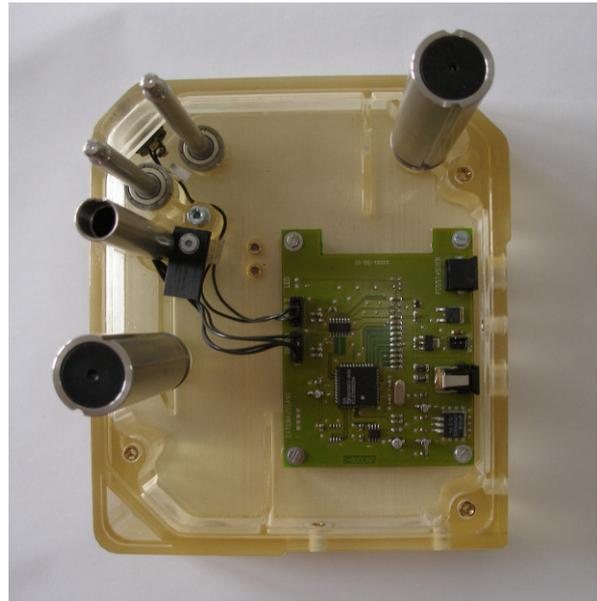
Bild 27 - Gehäuse mit teilweise montierten Bauteilen für ein Laborgerät, welches mit der Objet Technologie gefertigt wurde
