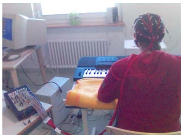
Abb. 11b: Patientin während der Versuchsdurchführung; links ein Computer, ausgestattet mit der Software MIDIport (M. Bangert, Neuroimaging Laboratory, Boston, MA, USA) zur Umwandlung der MIDI-Signale des elektronischen Klaviers und der Drum-Pads und Abgabe dieser als Triggerinformation in den EEG-Verstärker.
