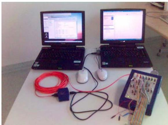
Abb. 11a: Darstellung des portablen EEG-Systems: Laptop links, ausgestattet mit einer Präsentationssoftware ® (Neurobehavioral Systems, Inc. Albany, CA); Laptop rechts, ausgestattet mit der EEG-Aufzeichnungs-Software eemagine (FA. eemagine Medical Imaging Solution GmbH, Berlin, D); REFA-Verstärker (Fa. TMS International, Enschede, NL); Glasfaserkabel; Fusbi „Fiber Interface module USB 2 (Fa. TMS International, Enschede, NL); PCI-Karte.
