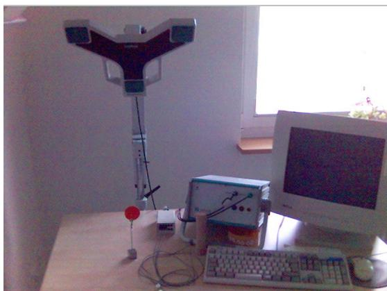
Abb. 4: Aufbau des Gerätes bestehend aus einem Messaufnehmer mit drei Mikrofonen, einem Grundgerät und Ultraschallmarkern. Mit dem angeschlossenen Computer können die Bewegungen direkt am Bildschirm verfolgt werden, während die dazugehörigen Daten bzw. Messwerte aufgezeichnet werden. Die Datenaufzeichnung erfolgte mit der Software WinData 2.19.3x, Fa. Zebris, Isny.
