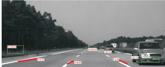
Abbildung 4.10: Spurerkennung mit der Hough-Transformation
