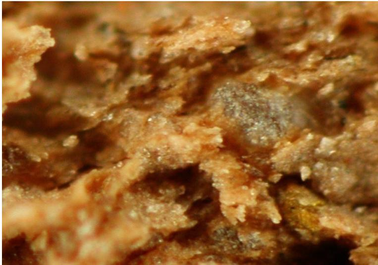
*Abb. 2: Bruchfläche eines getrockneten Dachziegelrohlings unter dem Auflichtmikroskop*
