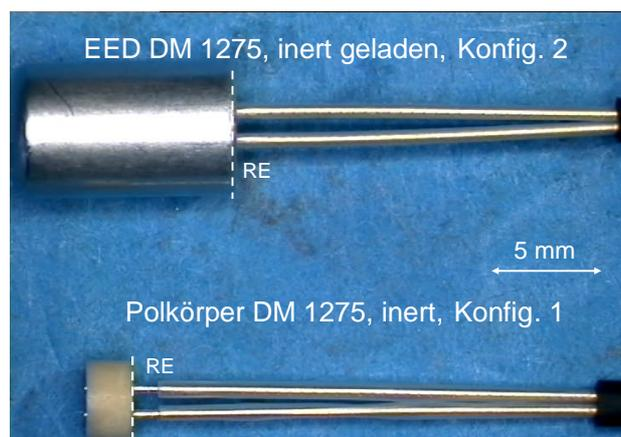
Bild 3-1: Polkörper DM 1275 inert (unten) und EED DM 1275, inert geladen (oben).
