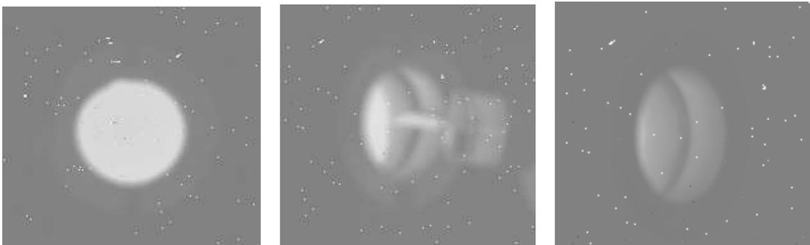
Bild 5-8: Visualisierung der emittierten Hohlraumstrahlung mittels einer Infrarotkamera für verschiedene Kamerawinkel (Links:  $0^\circ$ , Mitte:  $30^\circ$ , Rechts:  $40^\circ$ ).
