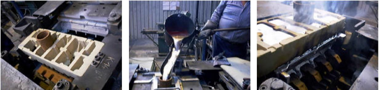
**Bild 55** Untersuchungen zur Formfüllung über Speiser
