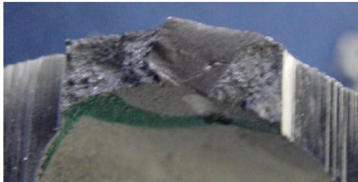
**Bild 29** Bruchfläche im undichten Bereich des Zylinderkopfes
