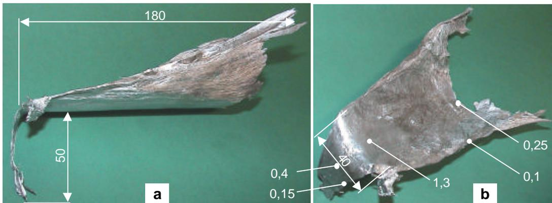
**Bild 78** Oxidhautreste nach dem Abguss von AlSi6Cu4 im Bereich der Gießschnauze mit den Gesamtabmessungen ( a ) und der Dicke ( b ) /Angaben in mm/
