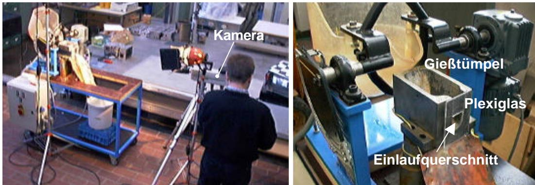
**Bild 83** Videotechnik für Strömungsaufnahmen an der Versuchsgießeinrichtung zur Strömungsmodellierung mit Wasser
