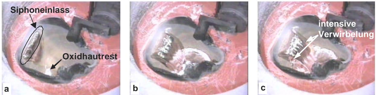
**Bild 77** Phasen der automatischen Löffelfüllung
