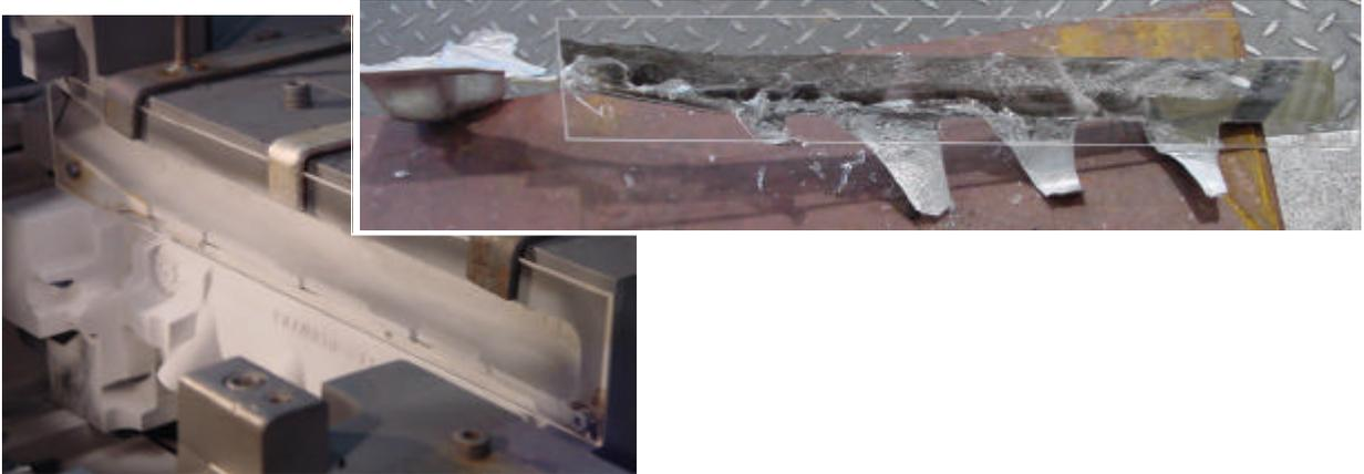
**Bild 102** Gießsystem mit Quarzglasscheibe und Querlauf nach unterbrochenem Abguss – erstarrende Schmelze unter den Anschnitten
