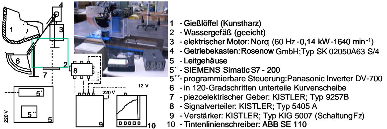
**Bild 80** Schematische Darstellung der Versuchsdosiereinrichtung
