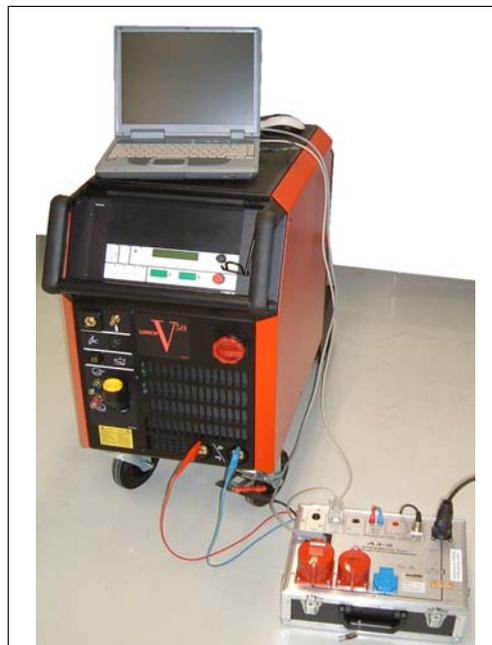
**Abb. 6.8** Ansicht eines kommerziellen Prüfsystems zur Wiederholungsprüfung von Lichtbogenschweißstromquellen
