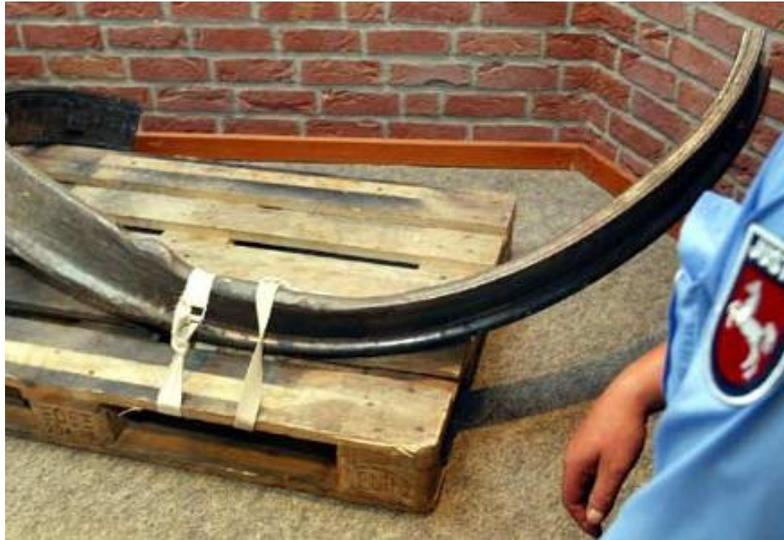
**Bild 1-4:** Der Radreifen, dessen Bruch zu der Katastrophe führte (Foto: dpa)
