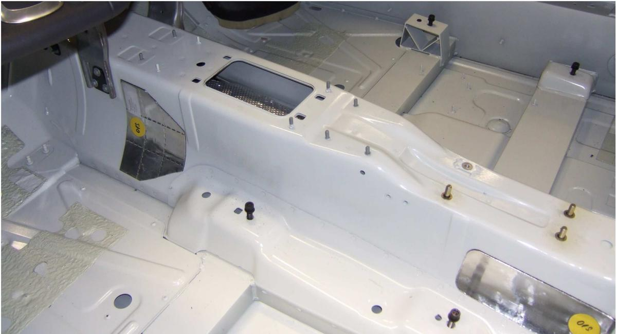
Abbildung 5.4.: Innenraumstruktur eines Fahrzeuges mit den Sitzquerträgern in Balkenform, dem Unterboden als ebenem Blech und dem Tunnel mit seinem typischen gebogenen Blech
