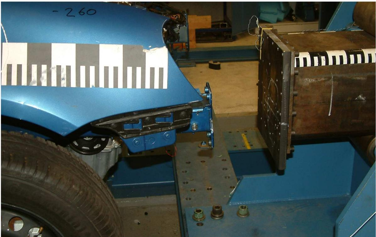
Abbildung A.2.: Hydraulik Stempel (rechts) zur Aufbringung von statischen Lasten analog zur Crashbelastung auf den Längsträger des Fahrzeuges (links)
