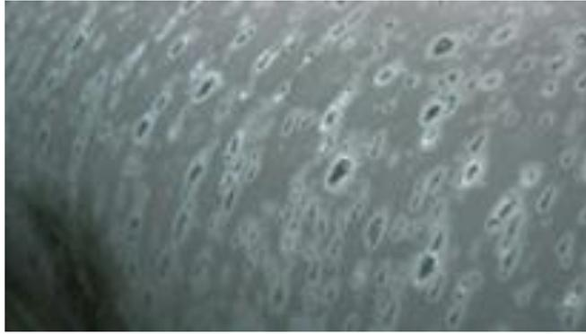
**Abbildung 2-2: Anhaftungen auf der Oberfläche einer getesteten luftgekühlten Ofenrolle aus Nicrofer 6025 HT**
