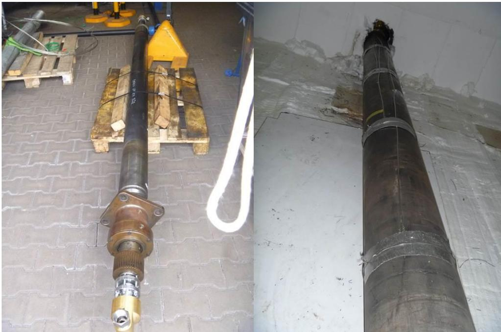
**Abbildung 3-14:** IST-Ofenrollen, links Bauform 2, rechts Bauform 1 im Versuchsofen
