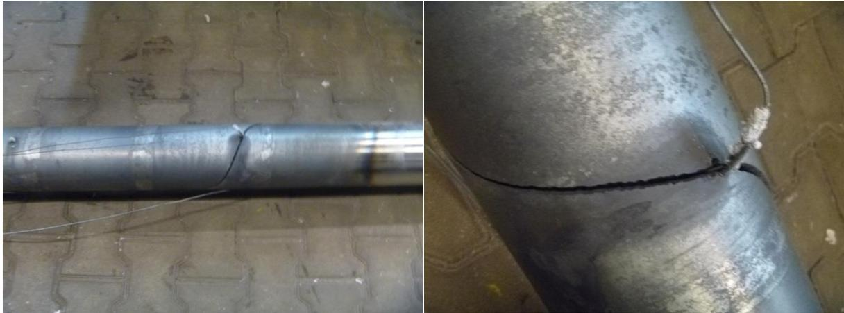
**Abbildung 5-4:** Fotografische Darstellung des „glatten“ Bruchs des äußeren Rollenmantels nach den Technikumsversuchen mit der zweischaligen Ofenrolle
