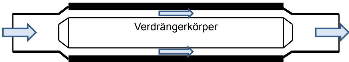
**Abbildung 2-4:** Exemplarische Darstellung einer Ofenrollebauform mit Wassereinlass linksseitig und Wasserauslass rechtsseitig
