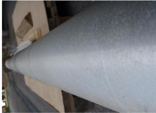
**Abbildung 5-9:** Mit Aluminium beschichtete Ofenrolle nach den Versuchen
