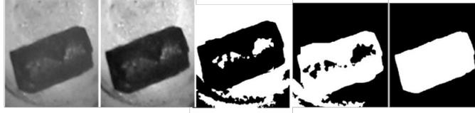
**Abbildung 4.12:** Vereinfachte Darstellung der automatisierten Umwandschritte vom Foto eines Pellets ( $l_{P,0} = 10 \text{ mm}$ ) hin zur binären Pixelmatrix
