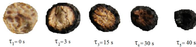
**Abbildung 4.16:** Phänomenologische Darstellung der Entgasungsphase eines ld2-Partikels bei  $T_B = 750 \text{ } ^\circ\text{C}$  während des Verbrennungsprozesses bis zu einer Verweilzeit von  $\tau = 40 \text{ s}$  im Laborwirbelschichtreaktor
