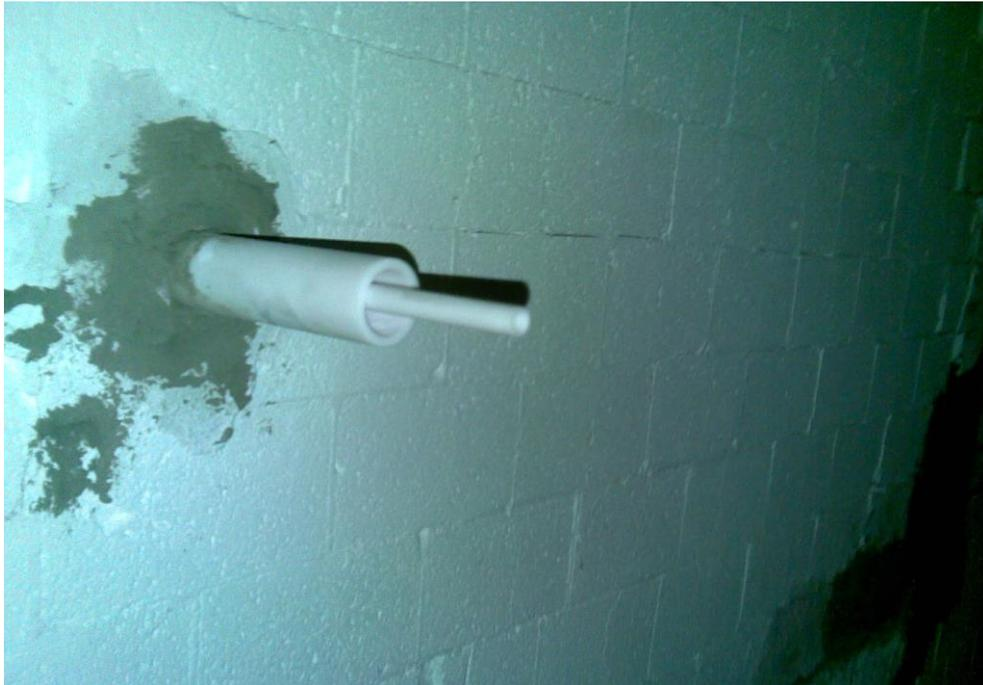
**Abbildung 4-2:** Fotografische Ansicht der eingebauten Probennahmesonde mit keramischem Führungsrohr im Ofen (Stranzinger, B.; Giese, R.; Mintus, F.; u.a. (2011))
