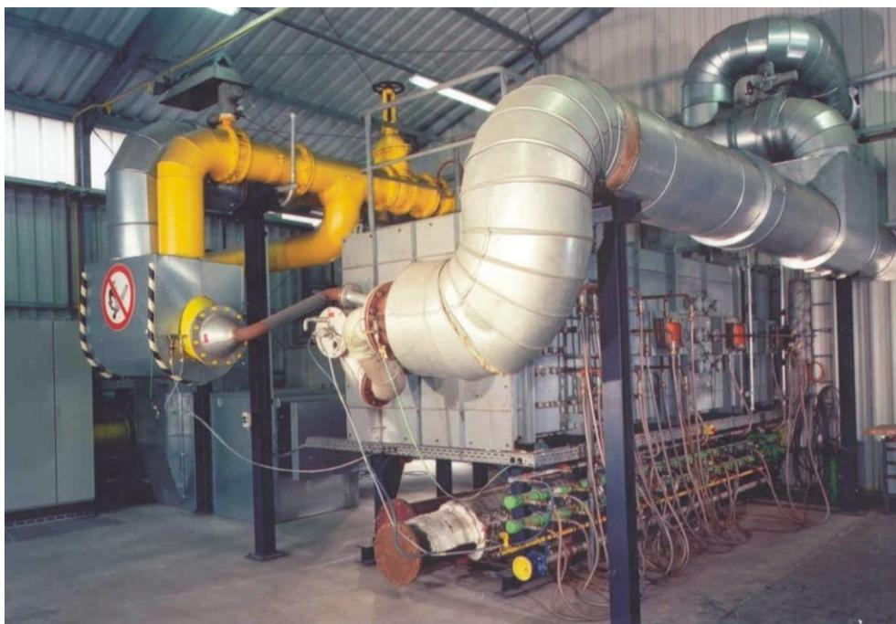
**Abbildung 3-24:** Fotografische Ansicht der Brennersuchsanlage des BFI auf dem Werksgelände von HKM (Stranzinger, B.; Giese, R.; Mintus, F.; u.a. (2011))
