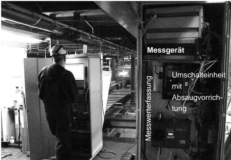
**Abbildung 4-4:** Fotografische Ansicht des neuen Messgerätes mit Analysenturm, Messwerterfassung, Umschalteinheit mit Absaugvorrichtung (Stranzinger, B.; Giese, R.; Mintus, F.; u.a. (2011))
