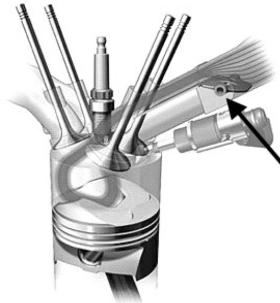
Abbildung 2.4: Darstellung der Generierung einer Tumbleströmung unter Verwendung einer LBK (gekennzeichnet durch den Pfeil) mit Unterstützung durch eine entsprechend geformte Kolbenmulde [12]
