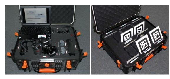
Abbildung 5-6: Setup AR-System:. Kamera und Laptop (li); Adapter mit Markern (re) [eigene Aufnahme]
