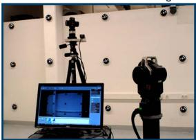
Abbildung 5-20: Kalibrierfeld ohne (links) und mit Photogrammetrieadaptern (rechts) [eigene Aufnahmen]
