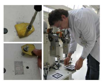
Abbildung 5-11: Montieren eines Betriebsmitteladapters an einer Referenzbohrung [eigene Aufnahme]
