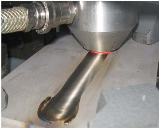
Abb. 1: Schweißen eines Stahls (S235JR,  $t = 5 \text{ mm}$ ) mit pcBN- Werkzeug und Schutzgasabdeckung (Quelle: HZG).
