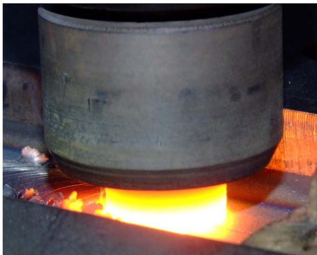
Abb. 2: Schweißen eines Stahls (S235JR,  $t = 5 \text{ mm}$ ) WRe-Werkzeug ohne Schutzgasabdeckung (Quelle: SLV B-B).
