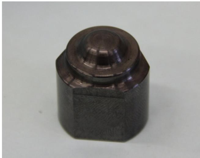
*Abb. 3: Keramisches Rührreibwerkzeug für 5 mm, Wechseleinsatz aus  $Si_3N_4$  (Quelle: SLV B-B).*
