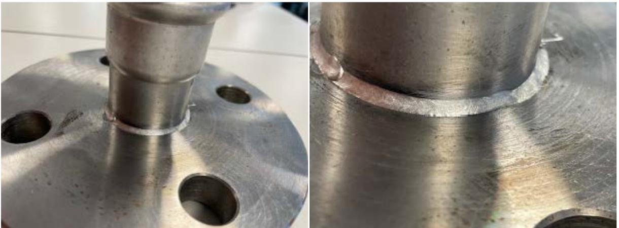
Hochlegierter Stahl mit dem Handlaser geschweißt mit Zusatzwerkstoff 1.4576 in 1,0mm und Stickstoff. Schweißgeschwindigkeit: 100 cm/min.
