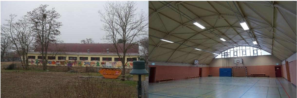
*Abb. 29 und 30: Kleinsporthalle ‚KT 60 L‘, hier in Magdeburg-Rothensee. Durch Gefälleumkehr der Flächenanbauten ist um das Jahr 2000 die anfällige Innenkehle vermieden worden. Die Stabnetzwerktonne im Inneren ist gut erhalten. Foto: Volker Mende, 2022.*
