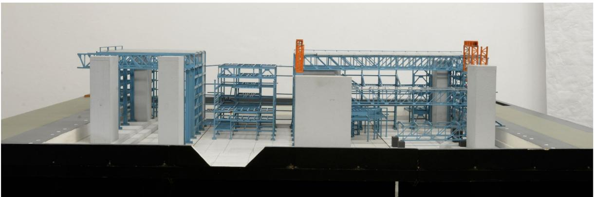
Abb. 4: Idealisertes Stahlbaumodell der Konstruktion des ‚Palast der Republik‘ in Berlin. Es zeigt einen, in der Realität nie so sichtbaren, Zwischenzustand der Tragwerksmontage. Rechts werden gerade mittels zweier Hubbühnen die 87-m-Binder über dem Großen Saal angehoben. M 1:100, Sammlung und Foto: Kustodie der TU Bergakademie Freiberg, 2022.
