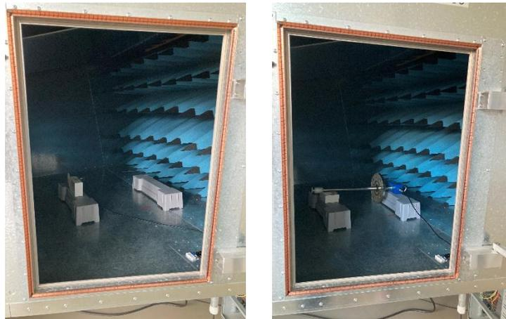
**Abbildung 4.9** Antennen an Position (3), links Spiralantenne, rechts UVS 610
