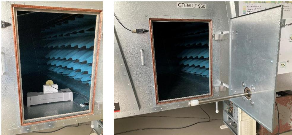
**Abbildung 4.7** Antennen an Position (2), links Spiralantenne, rechts UVS 610
