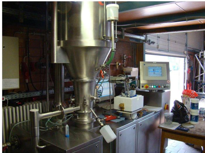
**Abbildung 3.8:** Darstellung der ProCell 5 Anlage von der Firma Glatt mit der dazugehörigen Peripherie
