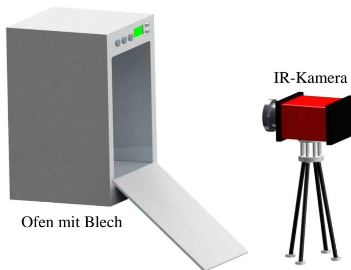
Abbildung 4. 3: Versuchsaufbau der Emissionsgradkalibrierung
