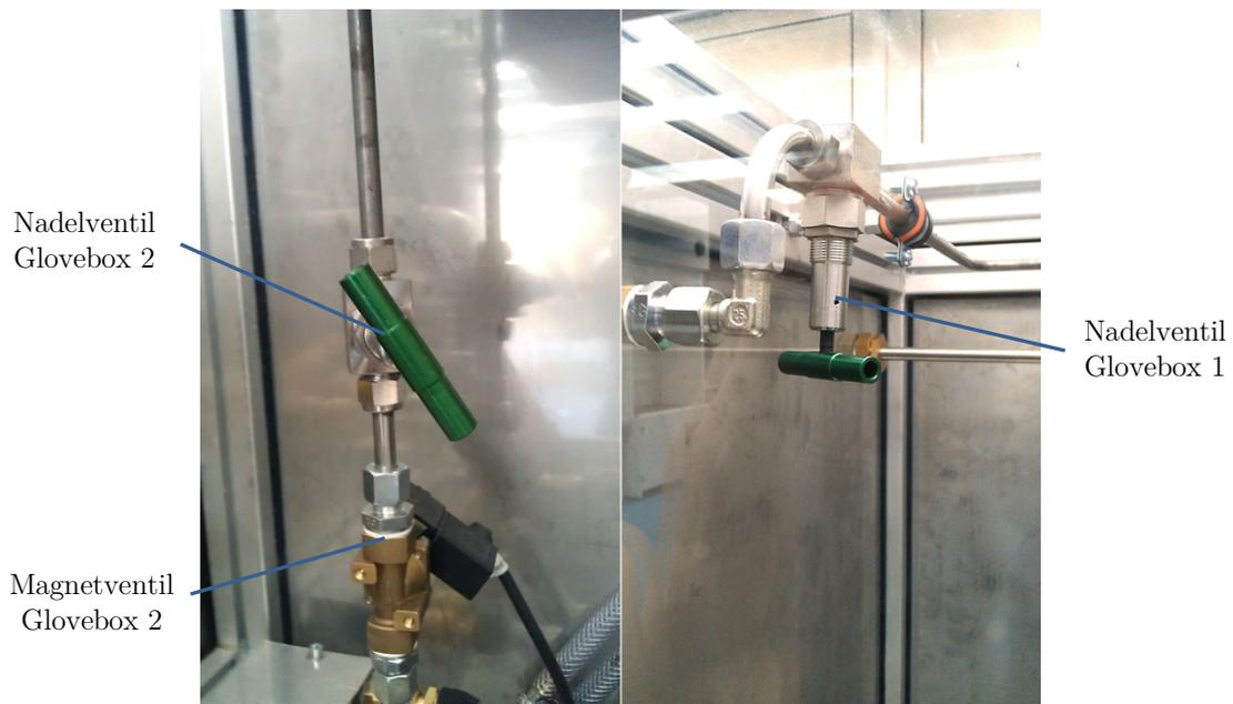
Abbildung 7-11: Ventile für die Inertisierung der Gloveboxen
