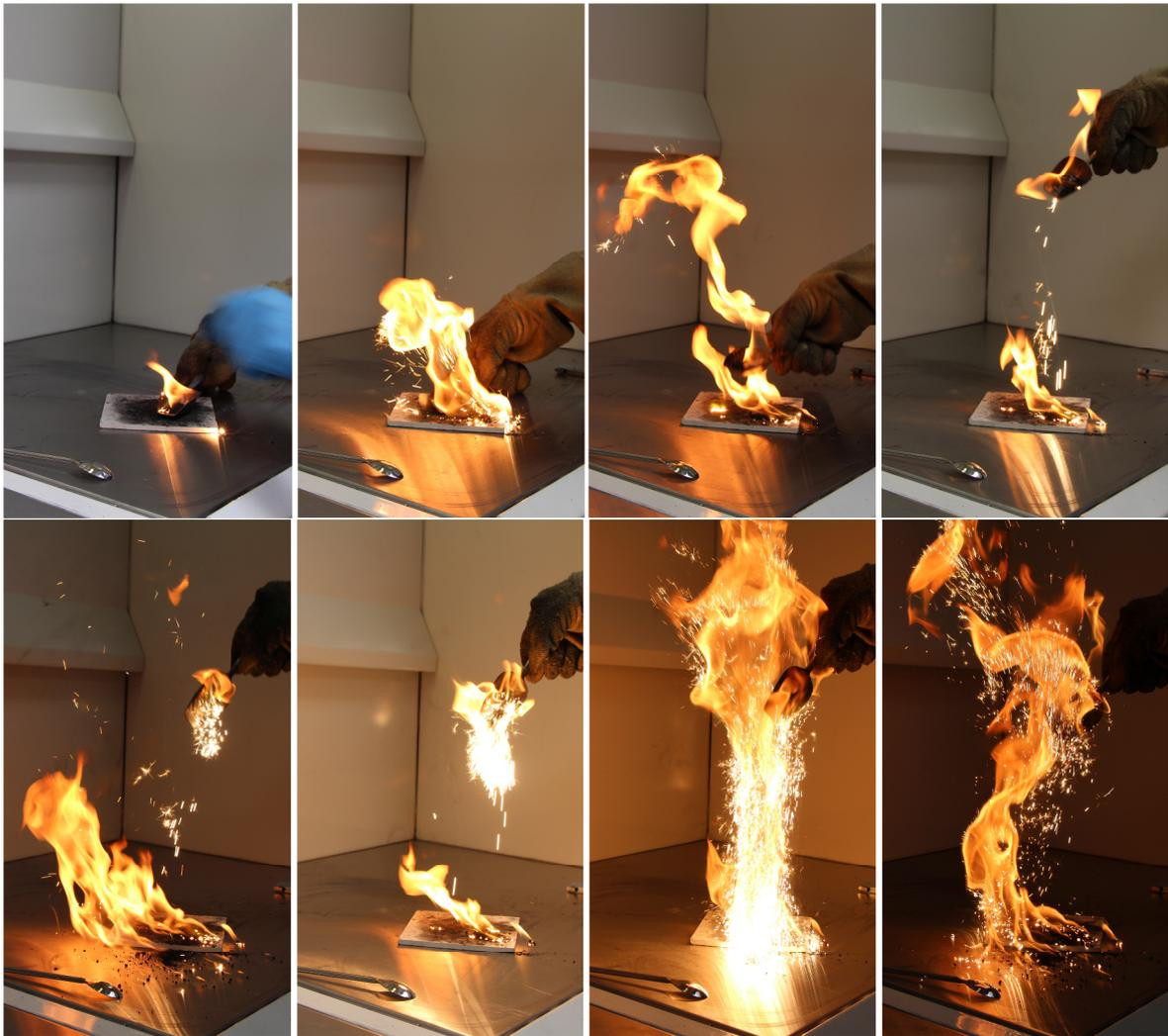
Abbildung 8-13: Pyrophorizitätsversuche mit feuchtem Titan
