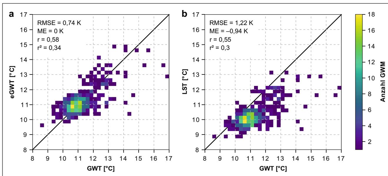
**Abb. 5** Streudiagramme zur Korrelation von **a** vorhergesagter (eGWT) und gemessener Grundwassertemperatur (GWT); **b** Land Surface Temperature (LST) und GWT. Die Farbe der Pixel zeigt die Anzahl der Grundwassermessstellen (GWM). Die Fehler werden durch den Root Mean Square Error (RMSE) und den Mean Error (ME) angegeben. Der Spearman-Korrelationskoeffizient wird mit  $r$  und das Bestimmtheitsmaß mit  $r^2$  angezeigt
