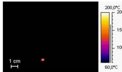
**Abb. 50:** Frontale Thermografieaufnahme ( $f_a = 850$  fps bei  $160 \times 120$  Bildpunkten) Hochspannungsfunkenzündung
