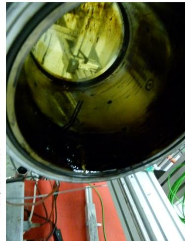
**Abb. 48:** Reaktionsrückstände nach Versuch Abb. 47
