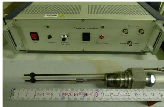
**Abb. 25:** Drahthalbwellenzündgerät mit Drahtzünder
