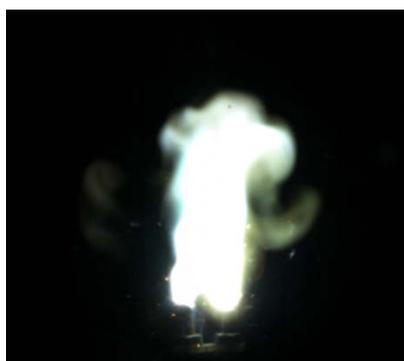
**Abb. 29:** Highspeedaufnahme ( $f_a = 5000$  fps) einer Schmelzdrahtzündung
