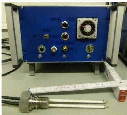
**Abb. 26:** Hochspannungstransformator mit Funkenzünder
