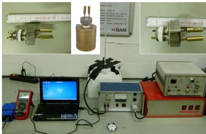
**Abb. 32:** Versuchsaufbau kalorimetrische Messungen: o. li.: Gleitfunkenzander, o. m.: Bombenkalorimeter, o. re.: Drahtzander, u.: Gesamtaufbau mit Zandgeraten und Messtechnik
