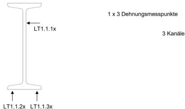
**Abbildung 5.39:** Messpunkte am Längsträger
