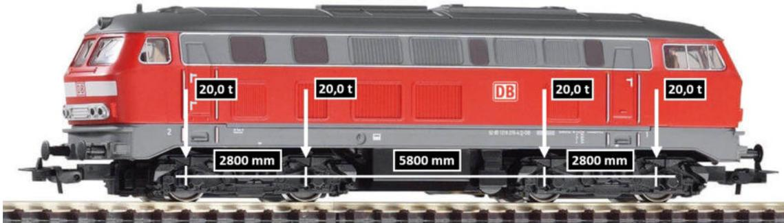
**Abbildung 5.10:** Belastungslok BR218 der DB mit ihren Achslasten und Achsabständen – Bildquelle: <https://tinyurl.com/2xbuqmk>
