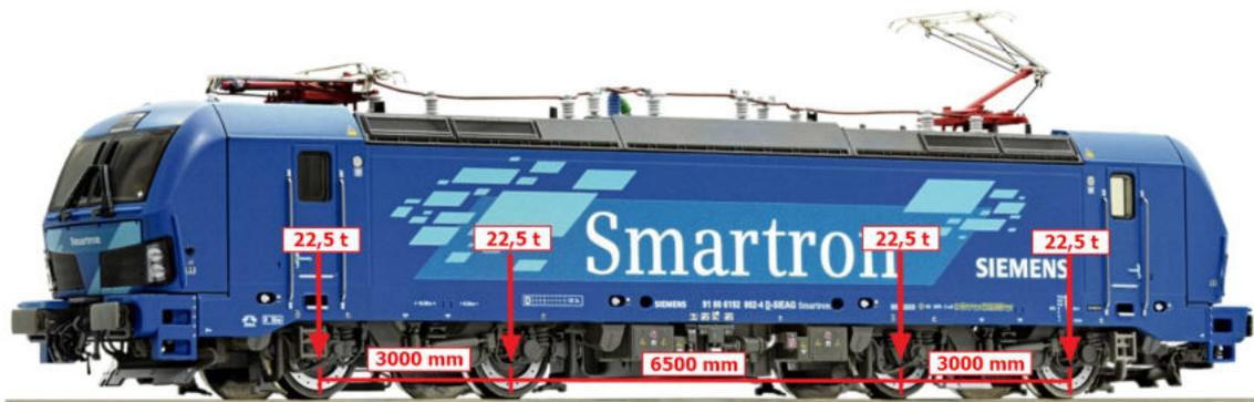
**Abbildung 5.40:** Belastungslok BR 192 „Siemens Smartron“ mit ihren Achslasten und Achsabständen – Bildquelle: <https://tinyurl.com/yc262fz7>
