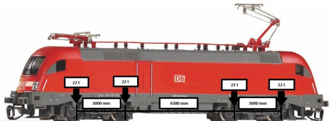
Abbildung 5.72: Belastungslok BR 182 mit ihren Achslasten und Achsabständen – Bildquelle: <https://tinyurl.com/2emdw2v6>
