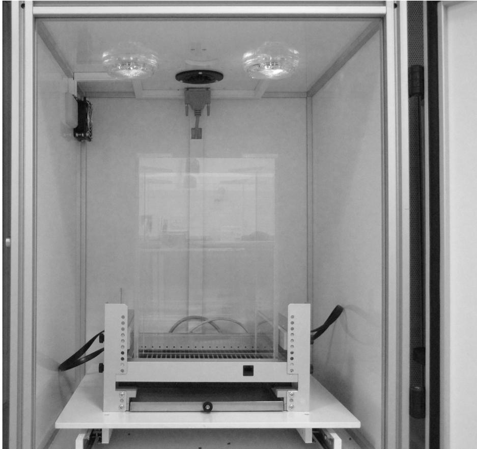
**Abbildung 2.1.** Dargestellt ist das Konditionierungssystem. Im unteren Bildbereich sind die Lichtschranken und die Metallstreben erkennbar. Außerdem wurde der durchsichtige Kunststoffbehälter eingesetzt.
