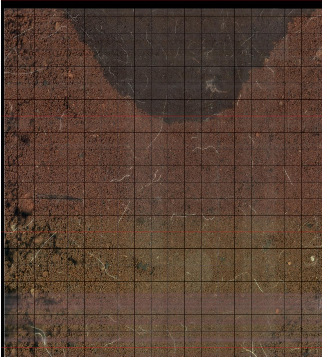
Abbildung 39: Wurzelscan inklusive Zählraster
