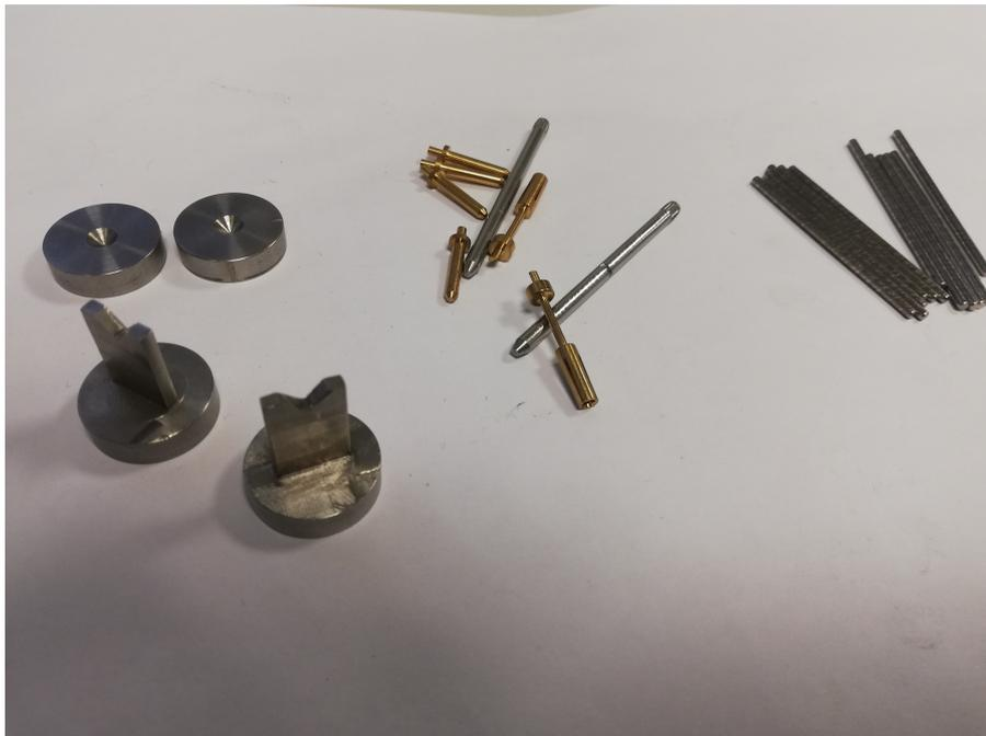
Abbildung 3.1: links: Stabhalterungen für Biegeschwingungen(vorn) und Längsschwingungen(hinten); rechts: Verschiedene Stabtypen
