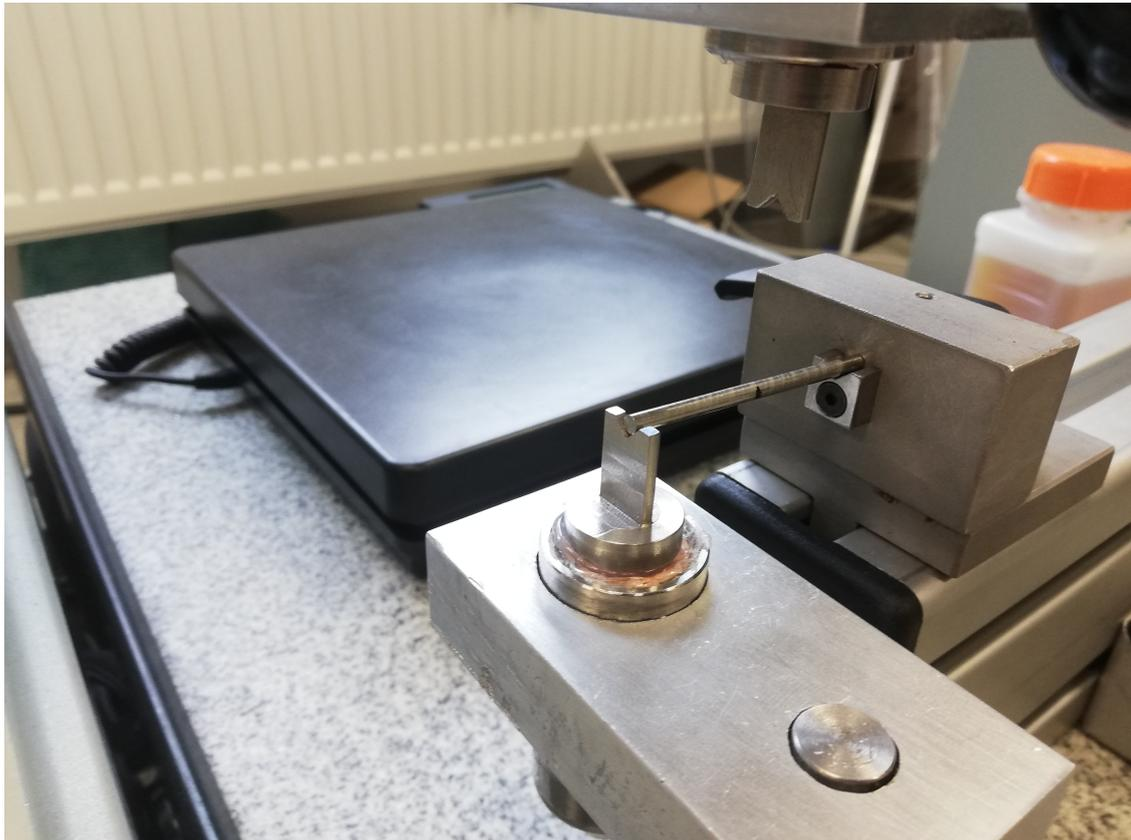
Abbildung 4.4: Stabhalterung für die Biegeschwingung
