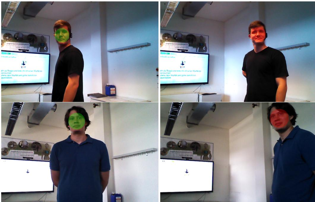
**Abbildung 8.10:** Qualitative Ergebnisse aus der Probandenstudie, aufgenommen aus der Perspektive des Roboters. Die grüne (Blickkontakt) und rote Schraffierung (kein Blickkontakt) deutet die Klassifikation des NITEC-Modells an.
