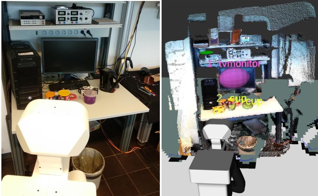
**Abbildung 5.11:** Implementierung der semantischen Kartierung in den TIAGo Roboter. Links: Reales Bild der Szene. Rechts: Kartierung durch den Roboter inklusive semantischer Objekte (*tvmonitor*, *cup*).
