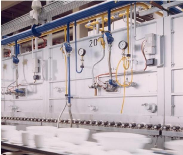
**Abb. 22:** Brenneinrichtung an einem Rollenofen [Bec5]
