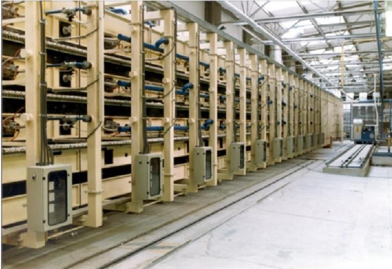
**Abb. 11:** Mehrkanal-Rollenofen zum Glühbrand von Porzellan [Bec8]
