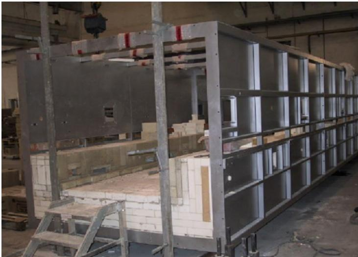
**Abb. 20:** Modul eines Rollenofens [Bec5]
