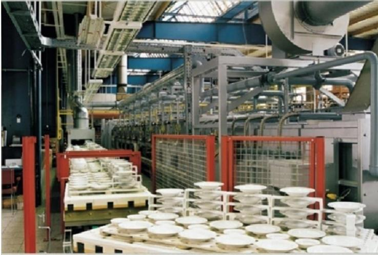
**Abb. 18:** Schnellbrandofen mit Wagenförderung zum Inglasur-Dekorbrand von Porzellan [Bec4].
