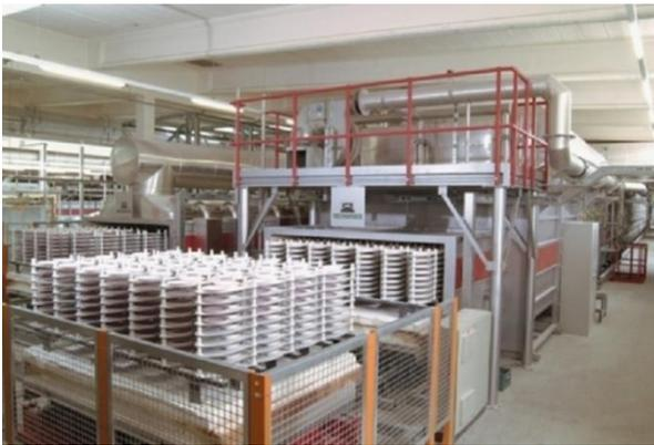
**Abb. 16:** Besatz eines Schnellbrandofenwagens für den Glattbrand von Porzellan [Bec2].
