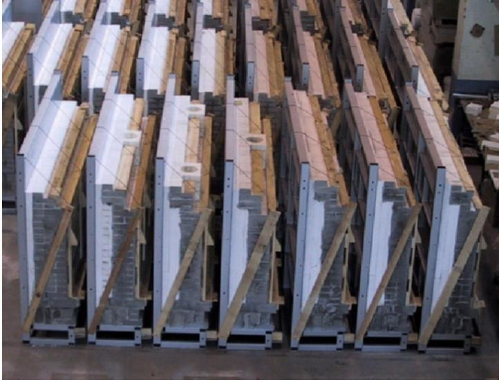
**Abb. 21:** Seitenmodule für einen Tunnelofen mit Wagenförderung [Bec5]
