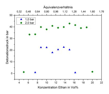
Abbildung 4.10 Detonationsdrücke von Ethan/Stickstoffmonoxid-Gemischen in Abhängigkeit vom Volumenanteil an Ethan und für verschiedene Initialdrücke
