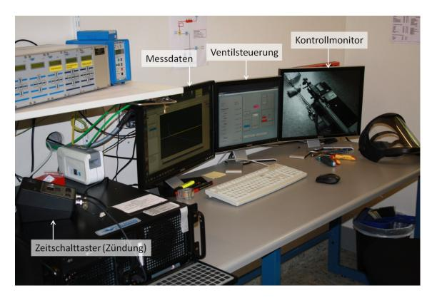
Abbildung 3.13 Steuerung und Kontrolle der Detonationsmessstrecke
