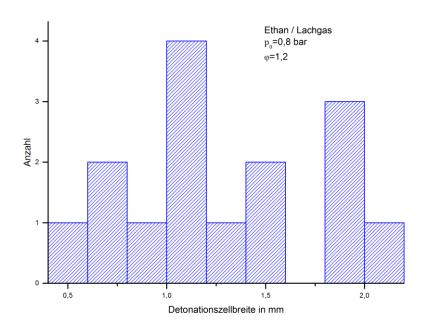
Abbildung 4.18 Verteilung der Detonationszellbreite bei verringertem Initialdruck
