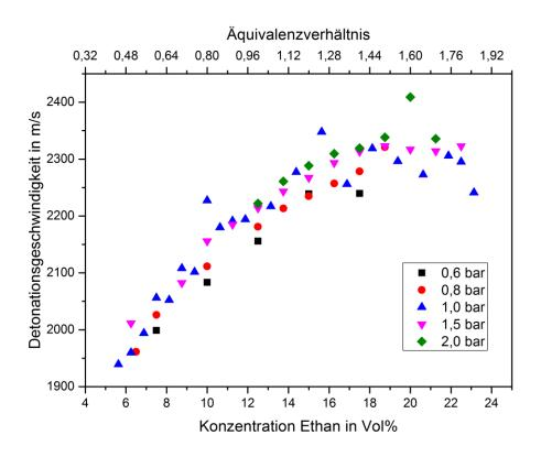
Abbildung 4.1 Detonationsgeschwindigkeiten von Ethan/Distickstoffmonoxid-Gemischen in Abhängigkeit vom Volumenanteil an Ethan und für verschiedene Initialdrücke
