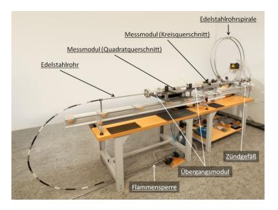
Abbildung 3.1 Detonationsmessstrecke
