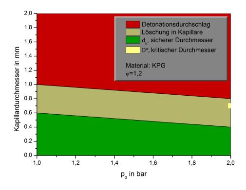
Abbildung 4.25 Detonationsverhalten und kritischer Durchmesser des Ethan/Stickstoffmonoxid-Gemisches in einer KPG-Kapillare
