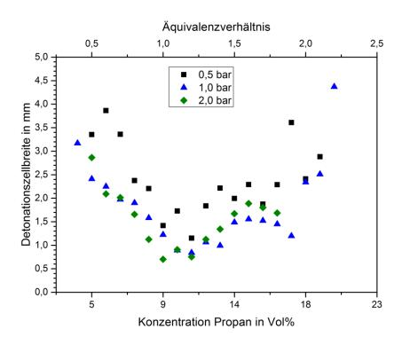
Abbildung 4.16 Detonationszellbreiten von Propan/Distickstoffmonoxid-Gemischen in Abhängigkeit vom Volumenanteil an Propan und für verschiedene Initialdrücke
