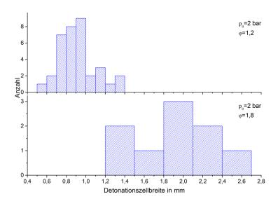
Abbildung 4.17 Konzentrationsabängige Verteilung der Detonationszellbreite eines Ethan/Distickstoffmonoxid-Gemisches
