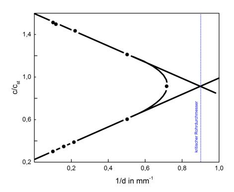
Abbildung 2.3 Zusammenhang zwischen der Zusammensetzung von Methan/Sauerstoff-Gemischen und dem kritischen Durchmesser nach [22]
