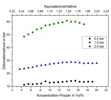
Abbildung 4.8 Detonationsdrücke von Propan/Distickstoffmonoxid-Gemischen in Abhängigkeit vom Volumenanteil an Propan und für verschiedene Initialdrücke
