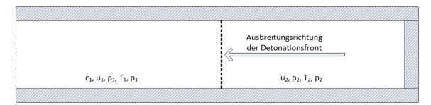
Abbildung 2.1 Schema der Detonationsausbreitung in Röhren und Kanälen
