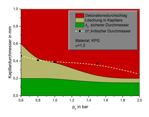
Abbildung 4.21 Detonationsverhalten und kritischer Durchmesser des Ethan/Distickstoffmonoxid-Gemisches in einer KPG-Kapillare
