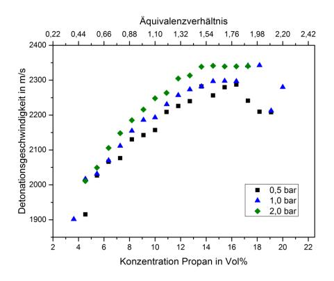
Abbildung 4.3 Detonationsgeschwindigkeiten von Propan/Distickstoffmonoxid-Gemischen in Abhängigkeit vom Volumenanteil an Propan und für verschiedene Initialdrücke
