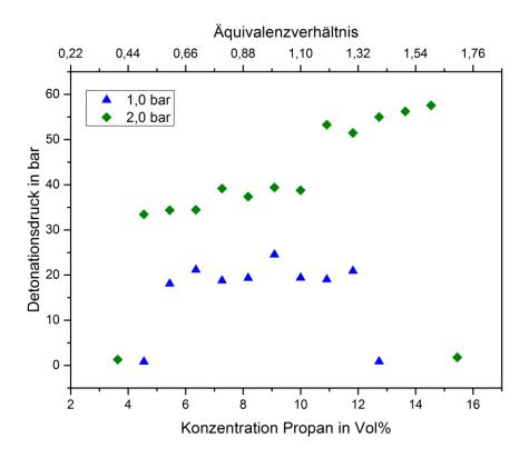
Abbildung 4.11 Detonationsdrücke von Propan/Stickstoffmonoxid-Gemischen in Abhängigkeit vom Volumenanteil an Propan und für verschiedene Initialdrücke
