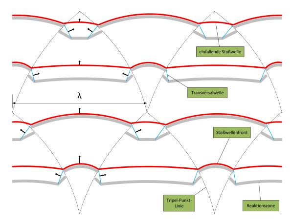
Abbildung 2.2 Mechanismus der Detonationszellenentstehung
