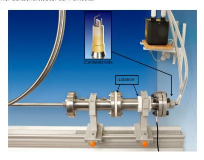
Abbildung 3.3 Zündvorrichtung mit keramischer Isolation
