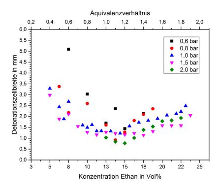
Abbildung 4.15 Detonationszellbreiten von Ethan/Distickstoffmonoxid-Gemischen in Abhängigkeit vom Volumenanteil an Ethan und für verschiedene Initialdrücke
