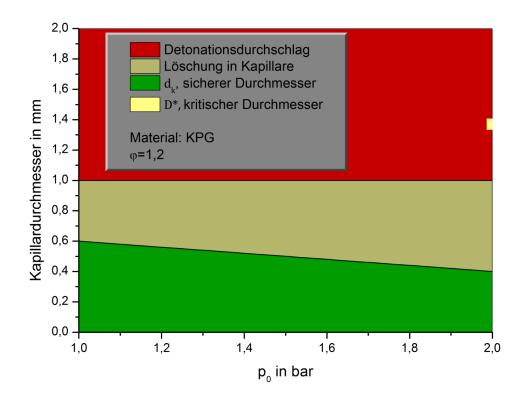
Abbildung 4.26Detonationsverhalten und kritischer Durchmesser des Propan/Stickstoffmonoxid-Gemisches in einer KPG-Kapillare
