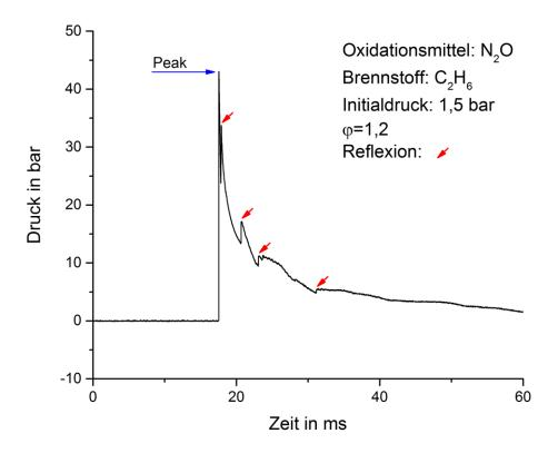
Abbildung 4.9 Druckverlauf der Detonation eines Ethan/Distickstoffmonoxid-Gemisches für einen Initialdruck von 1,5 bar
