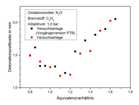
Abbildung 4.12 Einfluss der Versuchsanlage auf die Detonationszellbreite
