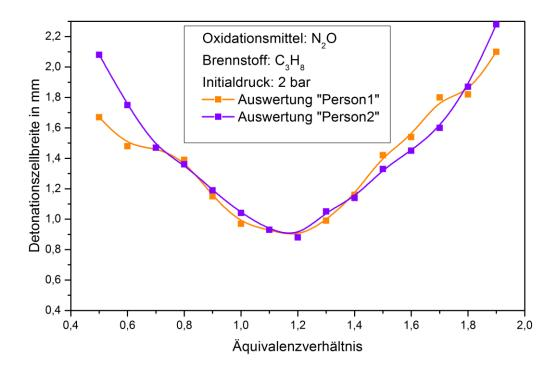
Abbildung 4.14 Abhängigkeit der Detonationszellbreite vom Äquivalenzverhältnis bei Auswertung durch zwei voneinander unabhängige Beobachter
