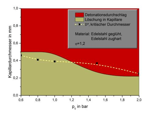
Abbildung 4.23 Detonationsverhalten und kritischer Durchmesser des Ethan/Distickstoffmonoxid-Gemisches in einer geglühten Edelstahlkapillare und einer zugharten Edelstahlkapillare
