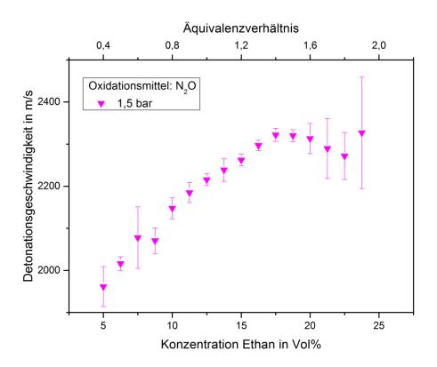
Abbildung 4.2 Mittlere Detonationsgeschwindigkeit und Standardabweichung beim Ethan/Distickstoffmonoxid-Gemisch in Abhängigkeit vom Volumenanteil an Ethan bei einem Initialdruck von 1,5 bar
