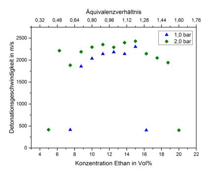
Abbildung 4.5 Detonationsgeschwindigkeiten von Ethan/Stickstoffmonoxid-Gemischen in Abhängigkeit vom Volumenanteil an Ethan und für verschiedene Initialdrücke
