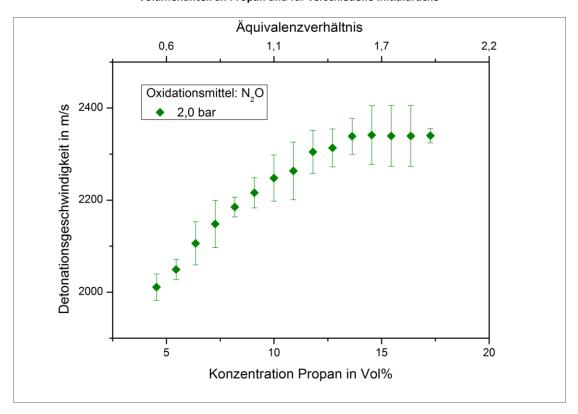
Abbildung 4.4 Mittlere Detonationsgeschwindigkeit und Standardabweichung beim Propan/Distickstoffmonoxid-Gemisch in Abhängigkeit vom Volumenanteil an Propan bei einem Initialdruck von 2 bar
