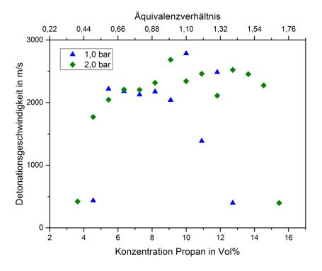
Abbildung 4.6 Detonationsgeschwindigkeiten von Propan/Stickstoffmonoxid-Gemischen in Abhängigkeit vom Volumenanteil an Propan und für verschiedene Initialdrücke
