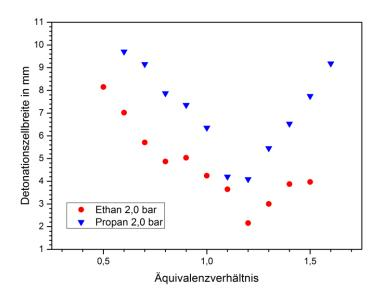
Abbildung 4.19 Detonationszellbreite von Gemischen mit Stickstoffmonoxid
