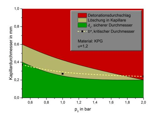
Abbildung 4.22 Detonationsverhalten und kritischer Durchmesser des Propan/Distickstoffmonoxid-Gemisches in einer KPG-Kapillare
