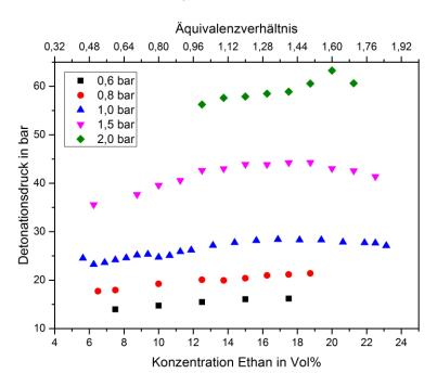
Abbildung 4.7 Detonationsdrücke von Ethan/Distickstoffmonoxid-Gemischen in Abhängigkeit vom Volumenanteil an Ethan und für verschiedene Initialdrücke
