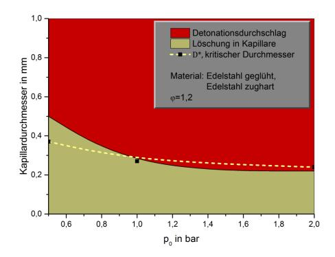
Abbildung 4.24 Detonationsverhalten und kritischer Durchmesser des Propan/Distickstoffmonoxid-Gemisches in einer geglühten Edelstahlkapillare und einer zugharten Edelstahlkapillare
