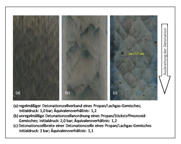
Abbildung 4.20 Rußbild von Detonationszellmustern
