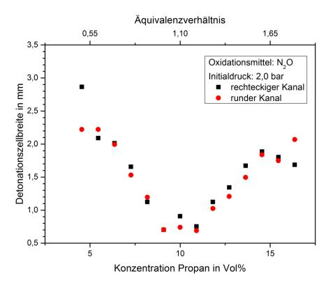
Abbildung 4.13 Detonationszellbreiten von Propan/Distickstoffmonoxid-Gemischen in Abhängigkeit vom Volumenanteil an Propan und in unterschiedlichen Kanalformen
