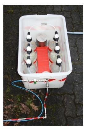
Abbildung 3.14 Waschkolonne mit regulierbarer Luftzuführung
