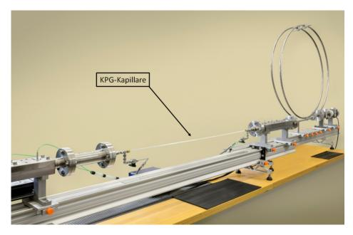
Abbildung 3.8 KPG-Kapillare eingebaut in Kapillarmodul
