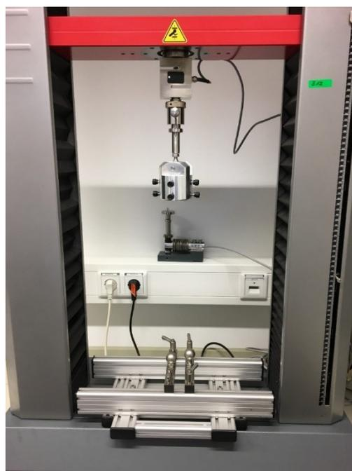
**Abbildung 11:** Materialprüfmaschine Zwick Roell Z010 (eigene Fotografie)
