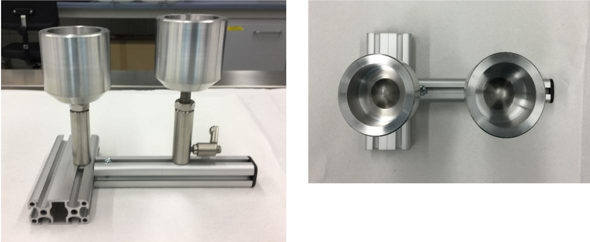
**Abbildung 8:** Formen für die Einbettungen der plantaren Positionen mit höhenverstellbarer Form (oben links) und konvexen Halbkugeln entsprechend der Prüfvorrichtung (oben rechts) (eigene Fotografie)
