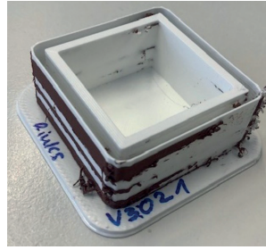
Musterbauteil (30mm Kantenlänge), Markierung in der Wand
