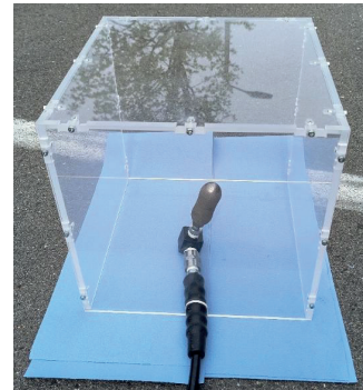
Berstdruckversuch mit maximalem Druck von 316 bar, Video auf LinkedIn (Link am Ende der Präsentation)
