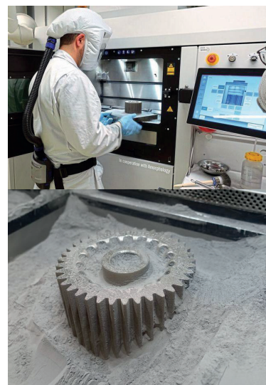
Entnahme eines Zahnrads (Masse 2 kg), hergestellt im PBF-LB/M-Verfahren aus amorphem Metall (Heraeus AMLOY)
