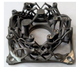
Festkörpergelenk aus 17-4 PH, gefertigt im PBF-LB-Verfahren
