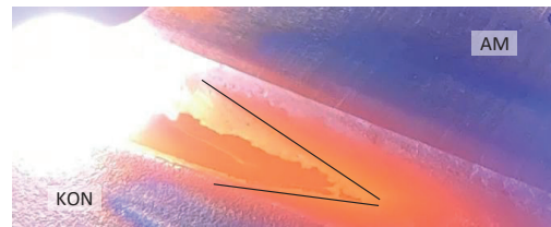
Abb. 6: Asymmetrische Schmelzbadablenkung zum KON-Grundwerkstoff beim WIG-Schweißen von hybridem AISI 316L.
