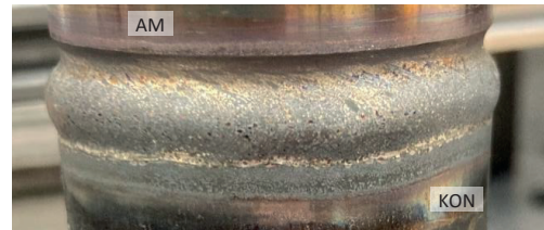
Abb. 2: Einbrandkerbe bei hybrider WIG-Schweißnaht, additiv gefertigtes Rohr mittels DED-LB(p), AISI 316L.
