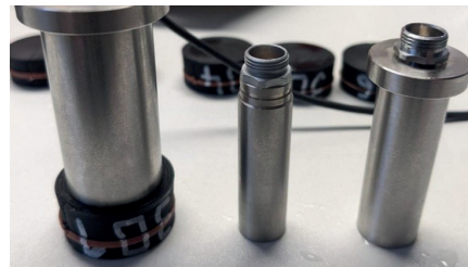
Puls-Echo-Messung an einfachem Testkörper
