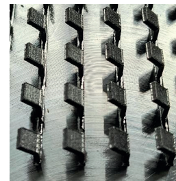
Parameterstudie an dickwandigen Segmenten im 45°-Winkel
