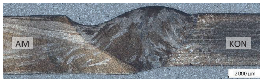
Abb. 4: Makroschliff einer hybriden WIG-Schweißverbindung, links DED-LB(p) (AM) und rechts KON, Grundwerkstoff AISI 316L.
