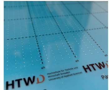
PA6/6.6 Partikel auf einer zuschneidbaren Folie (auch wasserlöslich möglich)
