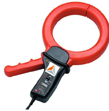
Abbildung 3.3: Strommesszange ab 0,5 mA [43]
