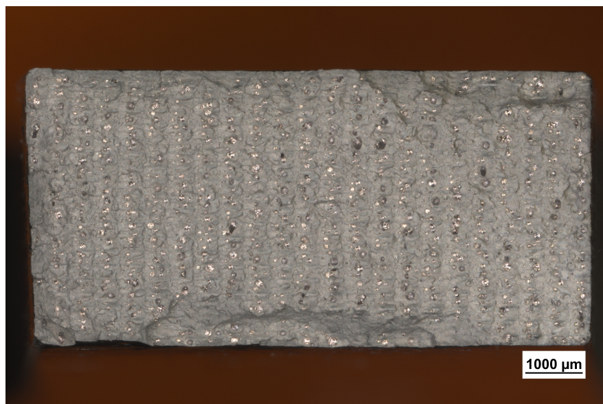
Abbildung A.13: Bruchfläche mit Gaseinschlüssen (Lunker) in der Bruchfläche, 10-fache Vergrößerung.
