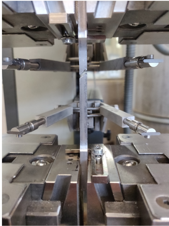
Abbildung 7.1: Gerissene Probe nach dem Zugversuch in der Maschine.
