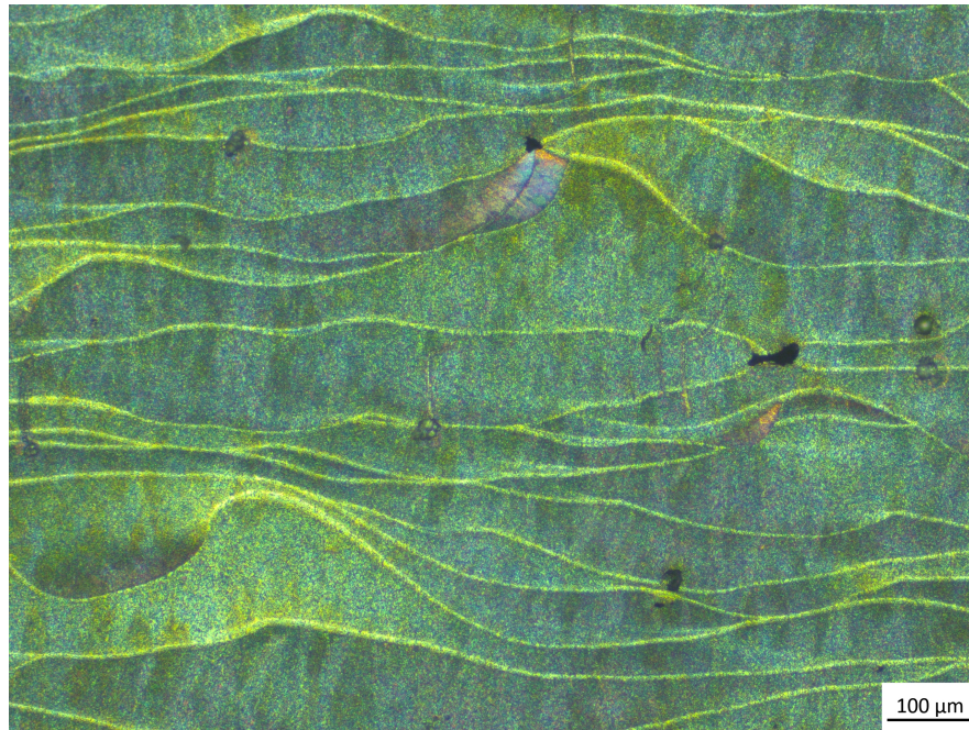
Abbildung A.2: Mikrostruktur der geätzten Probe y0 mit Murakami-Lösung bei 100-facher Vergrößerung, Querschliff, Keyhole-Fehler zwischen den Schichten.
