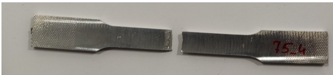
Abbildung 7.2: Gerissene Probe nach dem Zugversuch.
