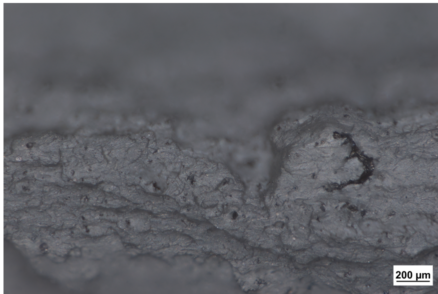
Abbildung 7.8: Bruchfläche mit Keyhole-Fehler im Bruchbereich, 50-fache Vergrößerung.
