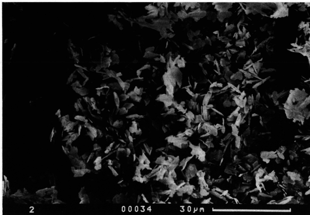
Abb. 62: REM-Aufnahme des Hydratationsproduktes der Einwaage \text{C}_4\text{AF} + \text{CaO} + \text{CaSO}_4 \cdot 2\text{H}_2\text{O} (laminare Phasen).
