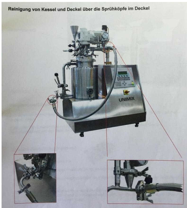
Abb. 16 : Verbindung für Vollreinigung
