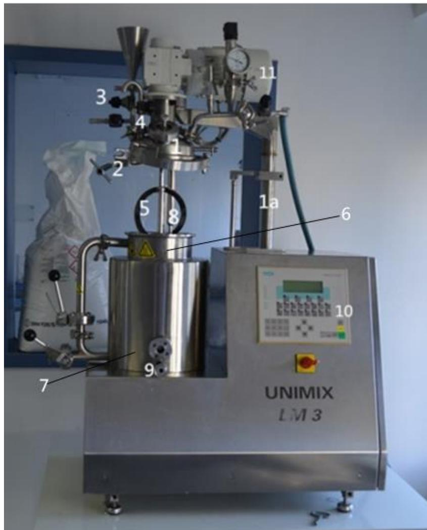
Abb. 7: Aufbau des EKATO UNIMIX LM3
