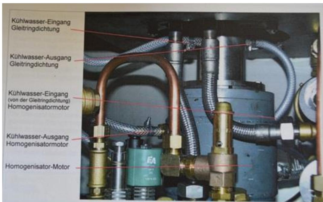
Abb. 8 : innere Konstruktion des EKATO UNIMIX LM3 [12]
