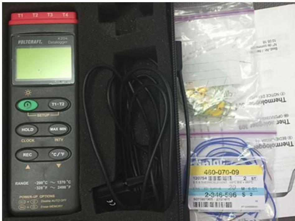
Abb. 11 :VOLT CRAFT Datalogger K204 mit Kanals
