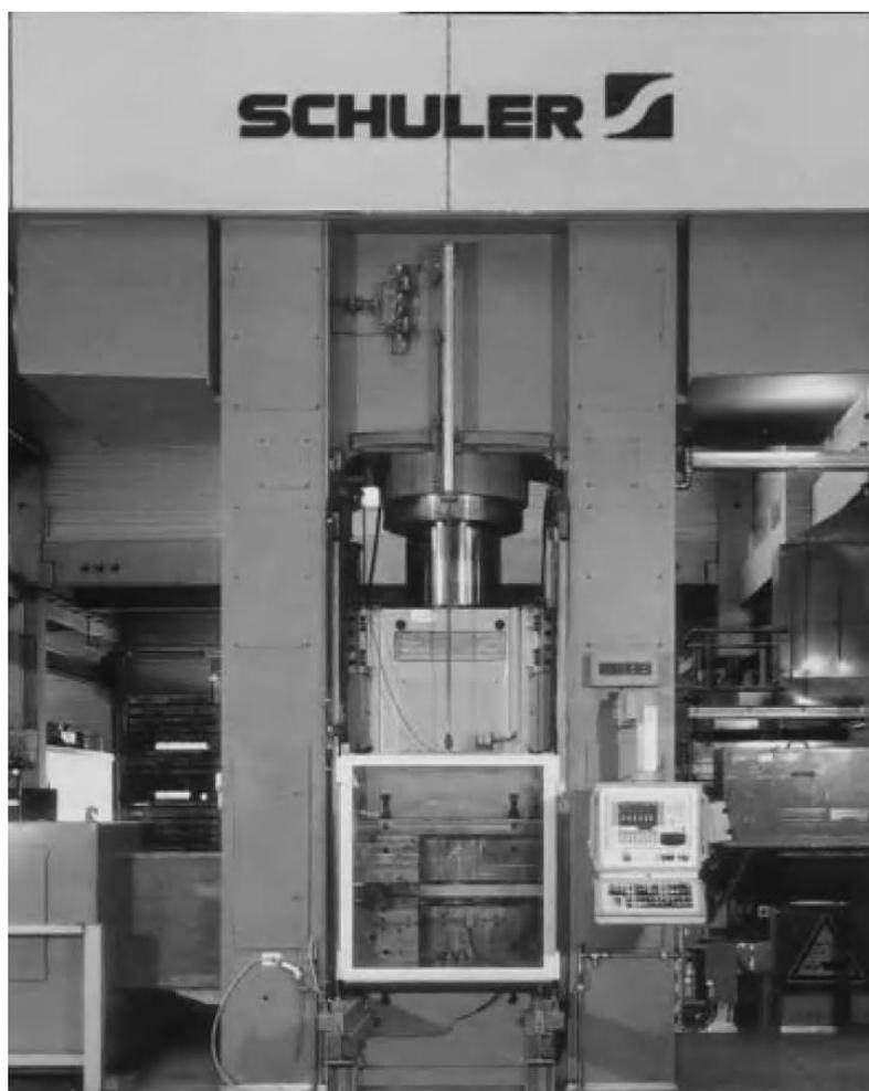
Abb. 31 Ölhydraulische Presse. Bild: Schuler AG<sup>(Lange et al. 2008 S.463)</sup>
