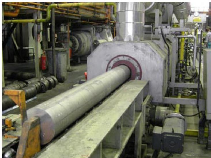
*Abb. 43 erhitzter Aluminiumbolzen* (Aluminium Profiltechnik GmbH)
