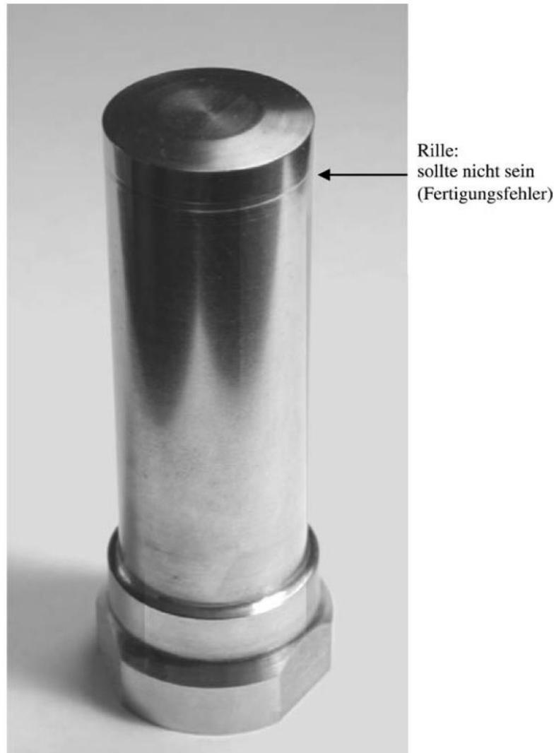
Abb. 20 Stempel für das Napf-Fließpressen. Die Anschliffe seitlich an der Stempelstandfläche dienen der Auf-
