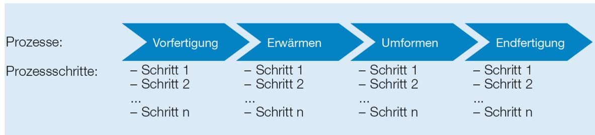
Abb. 41 Prinzipielle Prozesskette der Massivumformverfahren (Herbertz et al. 2013 S.69)
