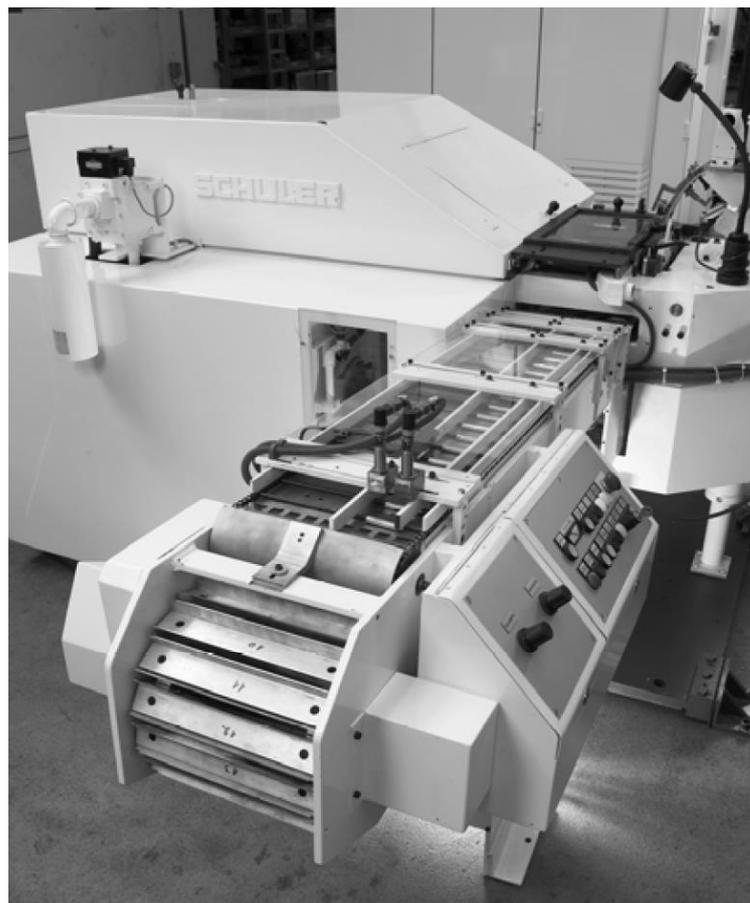
*Abb. 27 Einstufen-Kaltfließpresse mit Förderband* (Lange et al. 2008 S.439)
